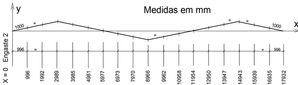
Figura 4.63 – Coordenadas dos modelos L18A10, L18A10S90a, L18A10S90b, L18A10S90IH como construídos
