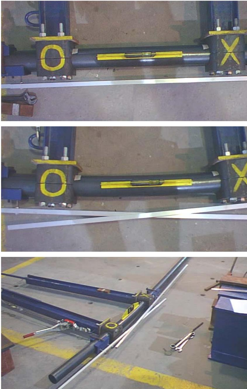
Figura 4.10 – Hastes de alumínio para determinação do ângulo
