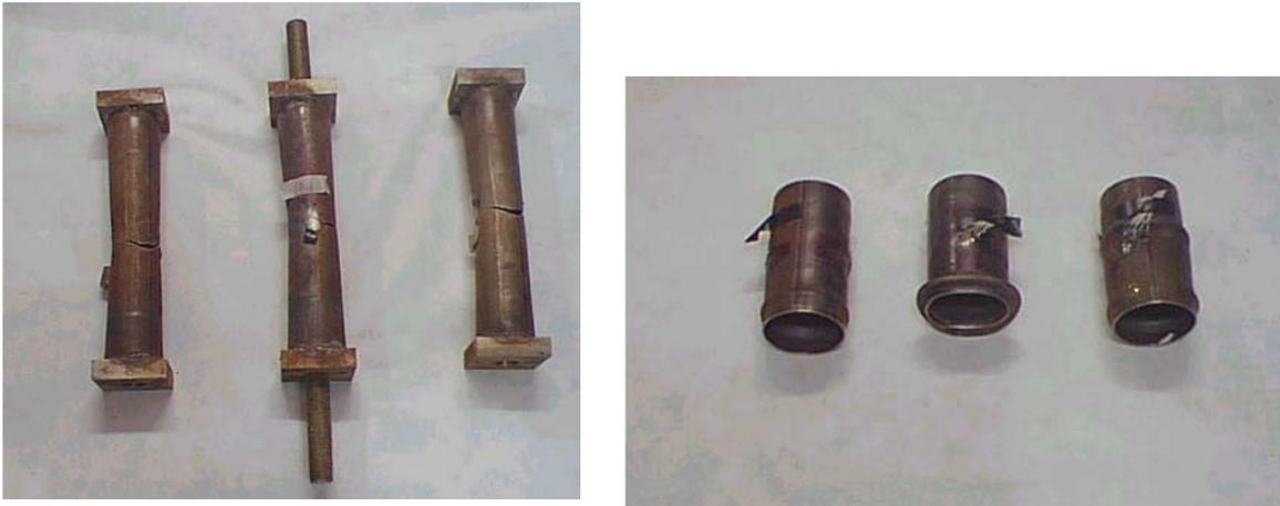
Figura 4.3 – Corpos de prova empregados no ensaio de tração e compressão axiais
