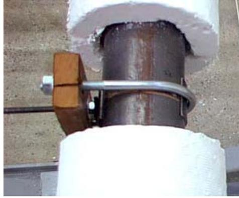
Figura 4.40 – Detalhe da ligação da barra que transmite a carga ao modelo
