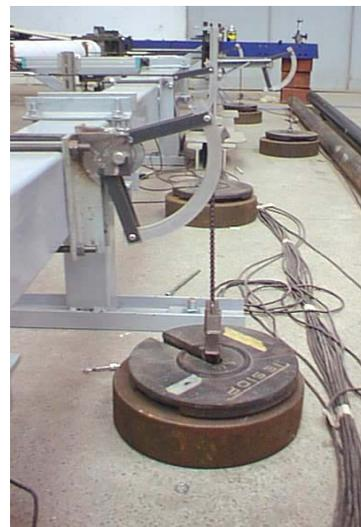
Figura 4.39 – Dispositivo para simular a força lateral de 88 kg/m
