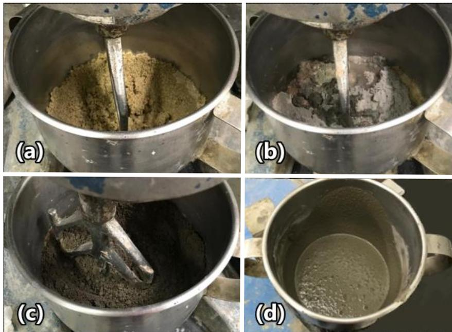
**Figura 3.2** - Etapas da mistura da argamassa: (a) areia com metade da água; (b) materiais cimentícios; (c) argamassa antes de adicionar o superplastificante e (d) após adicionar o superplastificante.
