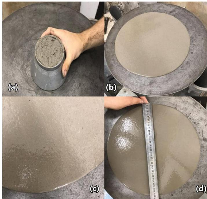
**Figura 3.3** - Etapas do espalhamento: (a) argamassa sendo colocada no tronco de cone; (b) argamassa após o espalhamento; (c) detalhe da borda, na qual é possível observar não haver segregação dos materiais e (d) medida do diâmetro.
