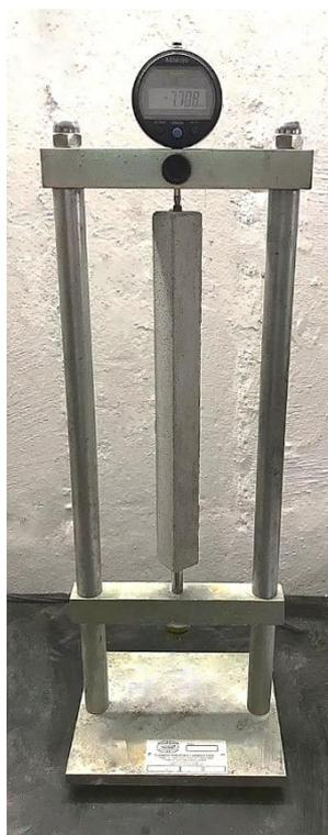
**Figura 5.5** - Pórtico utilizado para a medição das amostras de retração por secagem.
