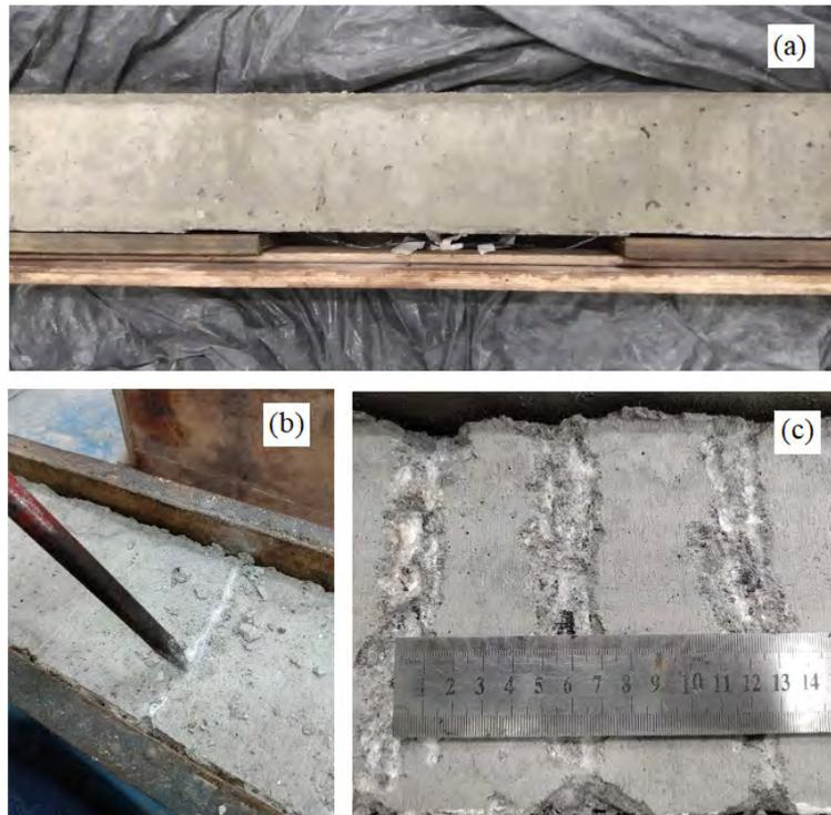
Figura 43 – Preparação da superfície para aplicação do reparo: (a) detalhe da forma, (b) ferramenta para produzir ranhuras e (c) espaçamento entre ranhuras.
