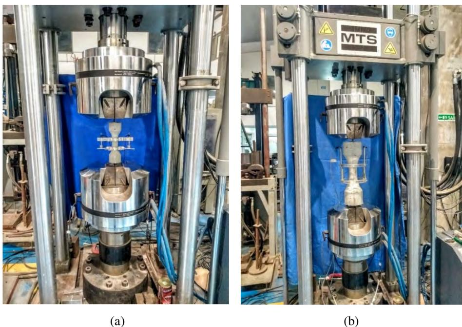
Figura 33 – Visão geral dos ensaios de tração direta: (a) corpo de prova pequeno e (b) corpo de prova grande.
