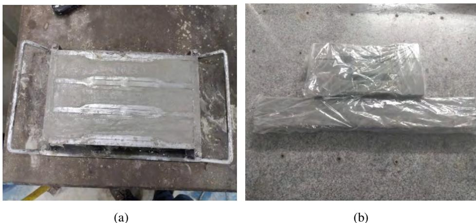
Figura 12 – Procedimentos utilizados para moldagem e cura dos materiais: (a) colocação dos materiais nos moldes e (b) estocagem dos corpos de prova.
