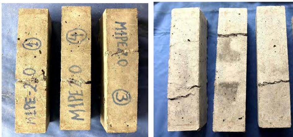
Figura 134 - Efeito-escala na flexão: M1PE2.0 (a) corpo de prova pequeno e (b) grande.
