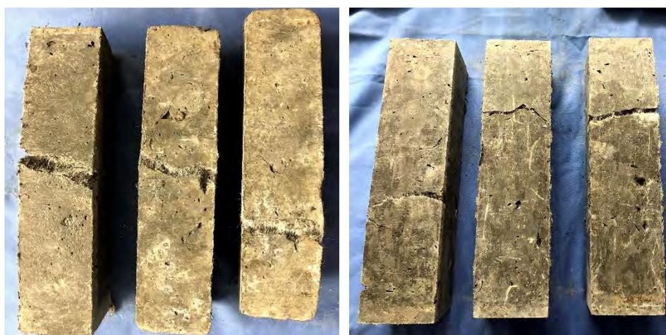
Figura 136 - Efeito-escala na flexão: M2PE2.0 (a) corpo de prova pequeno e (b) grande.
