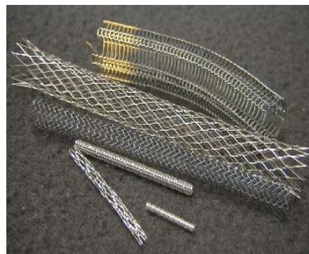
Figura 1.6 – Dispositivos auto-expansivos com memória de forma.
