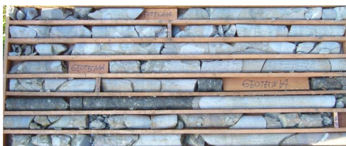
Figura 4.5 – Exemplo de testemunhos de rocha recuperados dos furos de sondagem executados no conglomerado meio-grosso no local da barragem do PHED.
