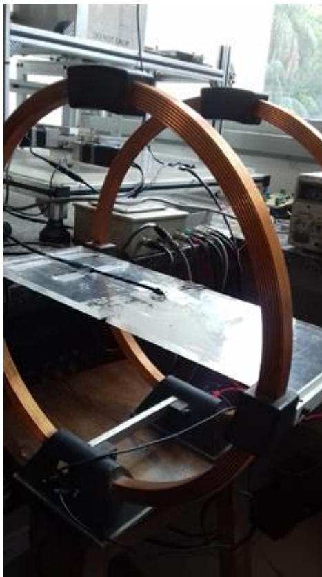
Figura 2.4: Par de Helmholtz com detector do gaussímetro dentro dele.
