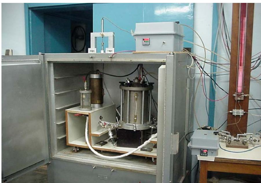
Figura 32 – Permeâmetro de temperatura controlada
