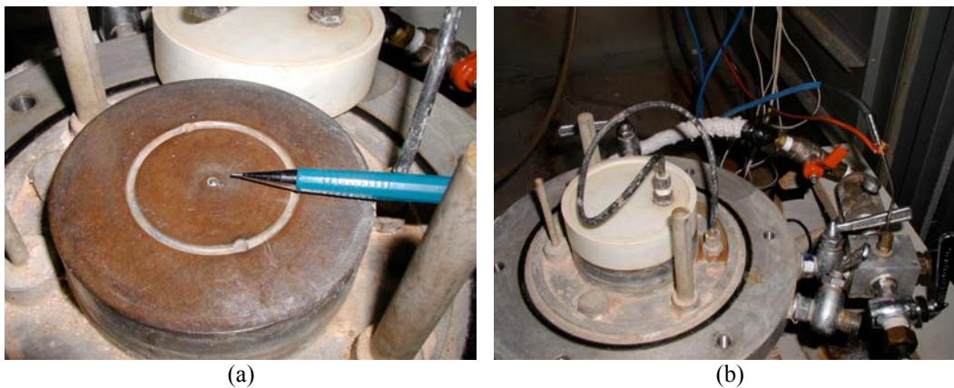
Figura 31 – Detalhe dos termopares instalados na base e no topo da amostra
