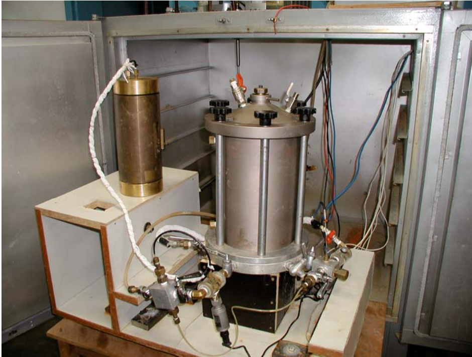
Figura 34 – Medidor de variação volumétrica com temperatura controlada.
