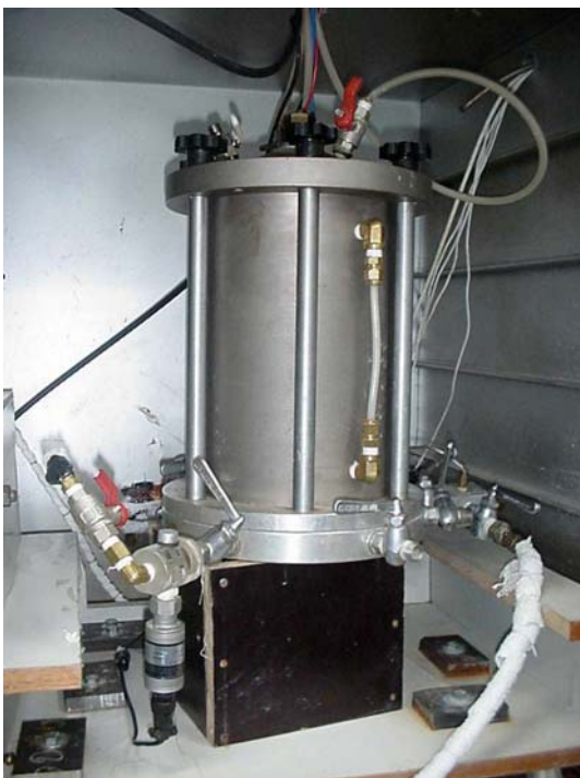
Figura 27 – Detalhe da câmara de aço
