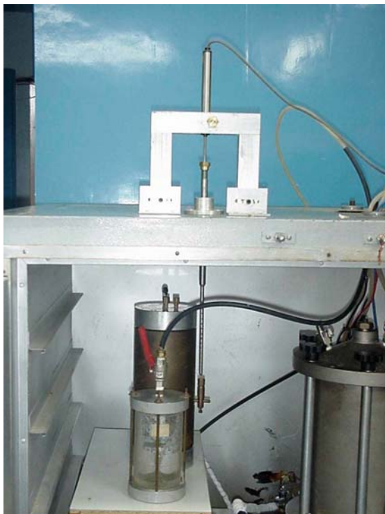
Figura 30 – Detalhe do medidor de variação de volume e do LSCDT
