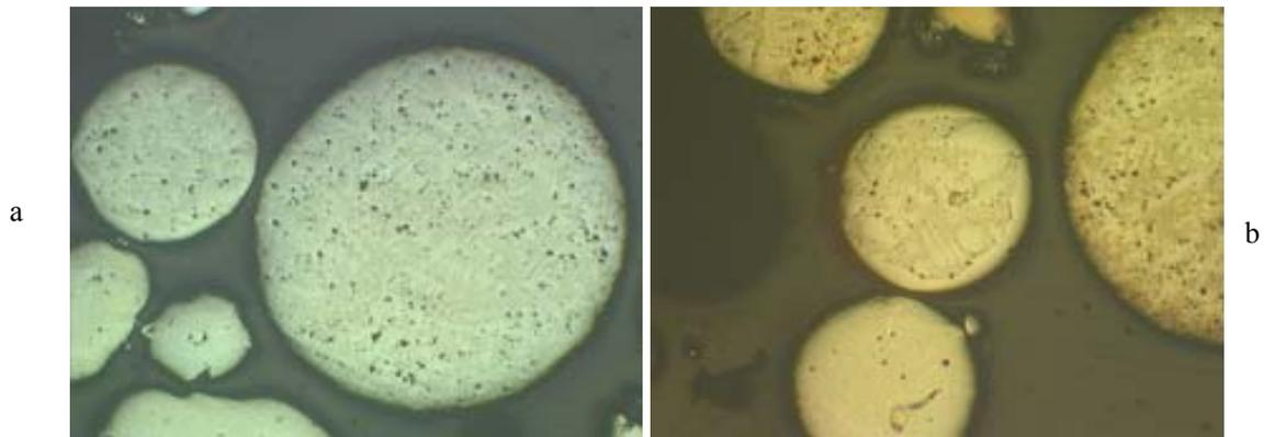
Figura 4.23 - Microscopia ótica : (a) amostra sem ataque químico; (b) amostra com ataque químico de nital 2%. Microestruturas dendríticas na superfície dos glóbulos; 1350°C; N<sub>2</sub>; 10min e 25X.
