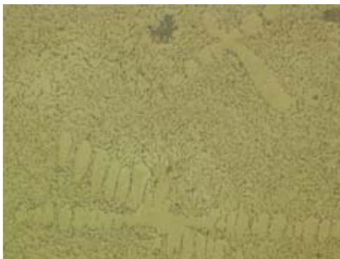
Figura 4.21 - Microscopia ótica. Ataque químico de nital 2%. Microestrutura dentrítica; 1300°C; N<sub>2</sub>; 45min e 100X.
