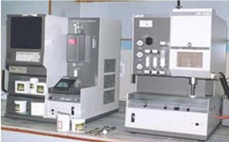
Figura 3.3 - Foto do analisador de Carbono, LECO-CS444.
