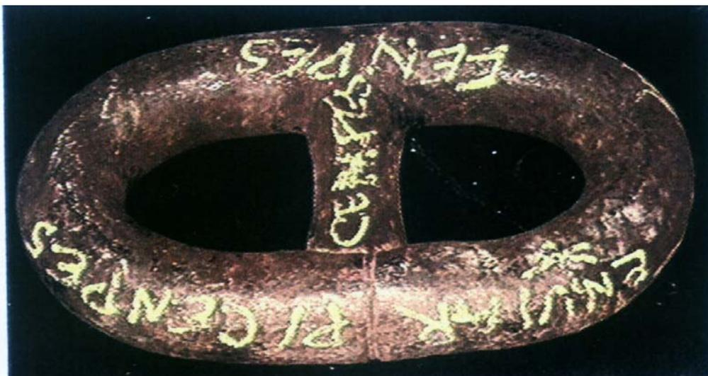
Figura 3.2 – Geometria típica de um elo com malhete após limpeza tipo ORQ com aplicações em sistemas de ancoragem *offshore*.
