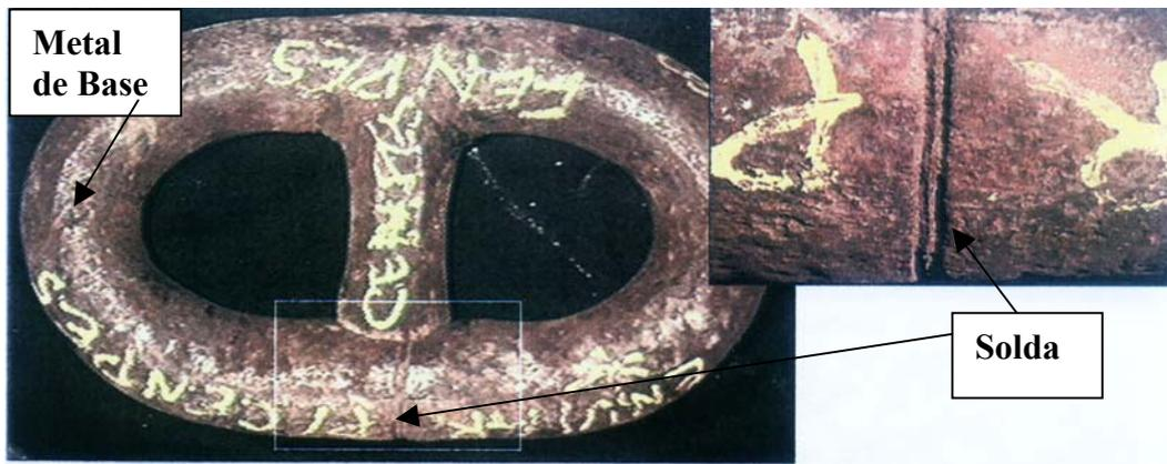
Figura 3.3 – Região de Solda e Metal de Base de onde foram retirados os corpos de prova utilizados nos ensaios mecânicos.
