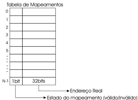
Figura 6.13: A tabela de mapeamento que é definida dentro de um estágio de armazenamento.
