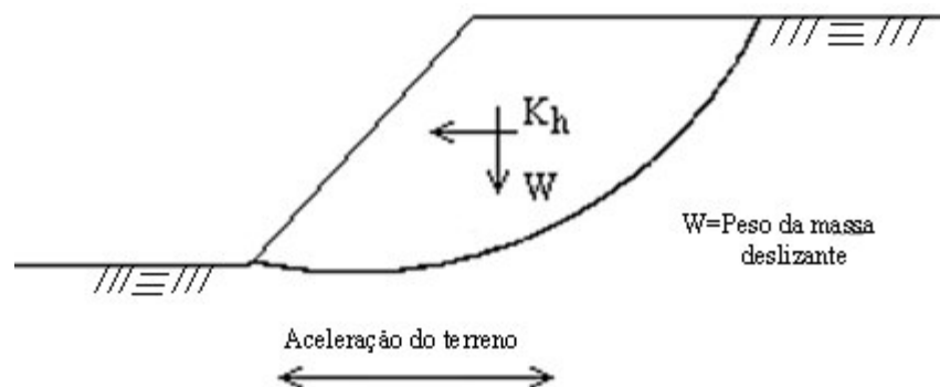
Figura 2.1 – Representação das forças de inércia na análise pseudoestática.
