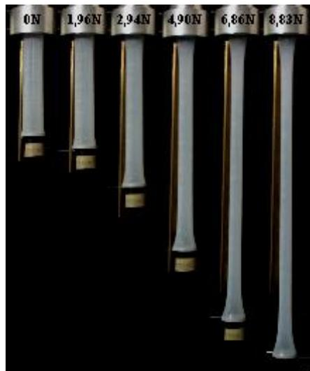
Figura 4.10 - Seqüência de deformadas ilustrando um ensaio de tração em membrana cilíndrica
