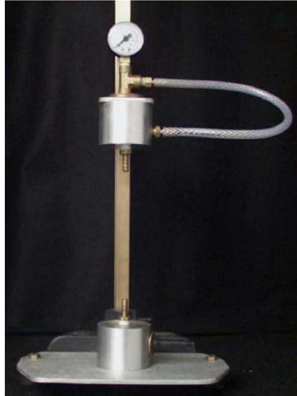
Figura 4.15 – Foto ilustrativa do aparato utilizado nos ensaios de cascas cilíndricas espessas sob tração e pressão
