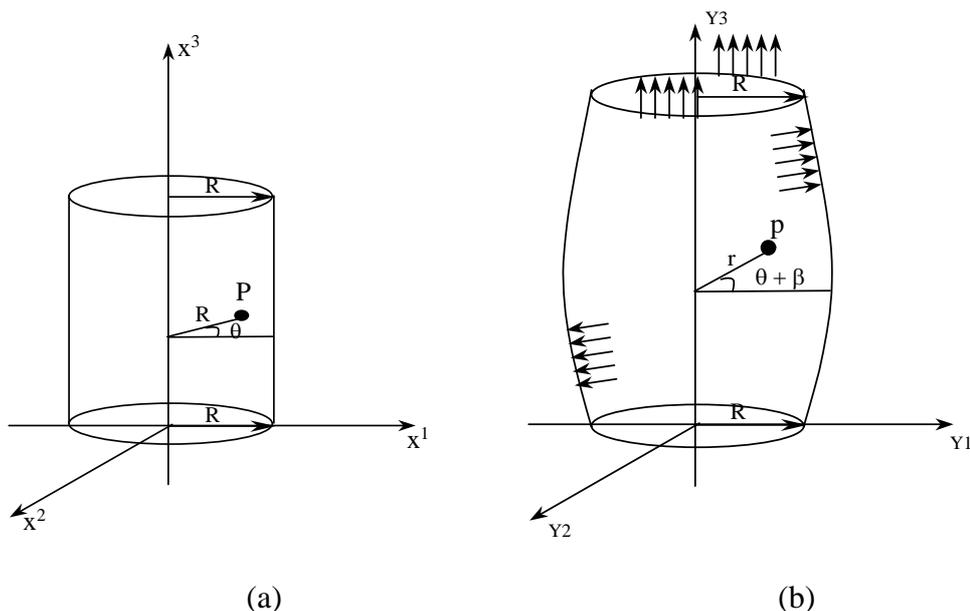
Figura 2.3 - Configurações indeformada e deformada da membrana cilíndrica
