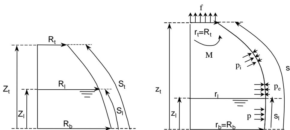
Figura 2.2- Coordenadas e possíveis carregamentos da membrana
