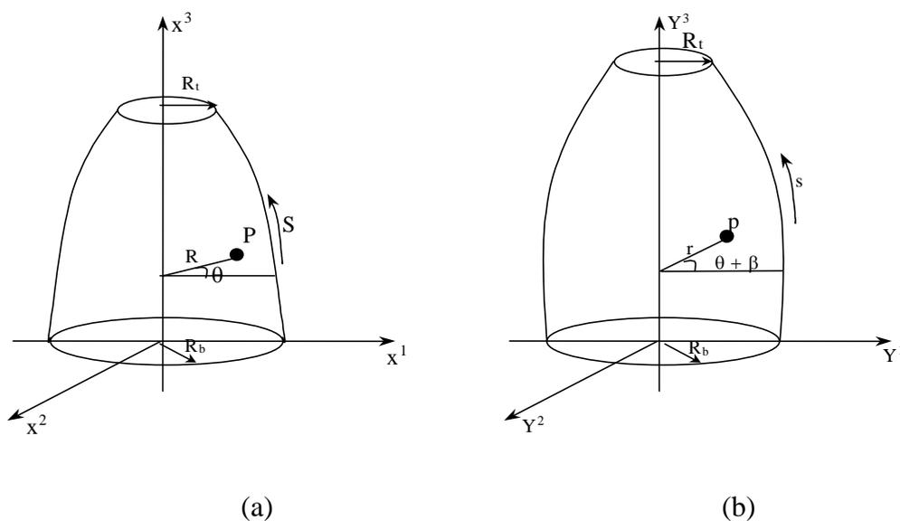
Figura 2.1 - Configurações indeformada e deformada da membrana
