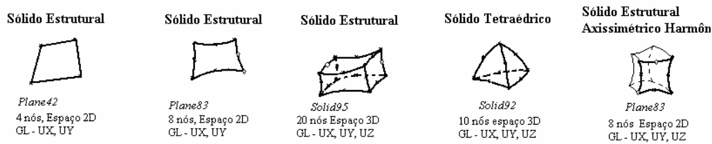
Figura A.1 – Resumo dos elementos utilizados nas análises tridimensional e axissimétrica.
