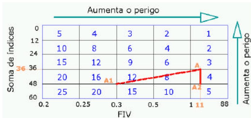
Figura 5.12: Matriz de Risco para o dano por corrosão no duto A-G enterrado.
