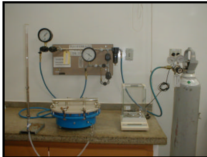
Figura 5.59 – Câmara de Pressão de Richards
