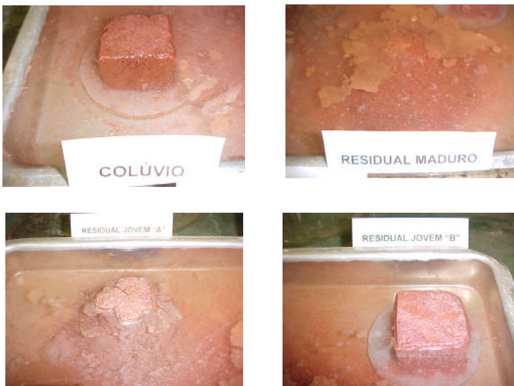
Figura 5.19 – Amostras colocadas sobre Pedra Porosa, Ensaio de Imersão Total (logo após a inundação)
