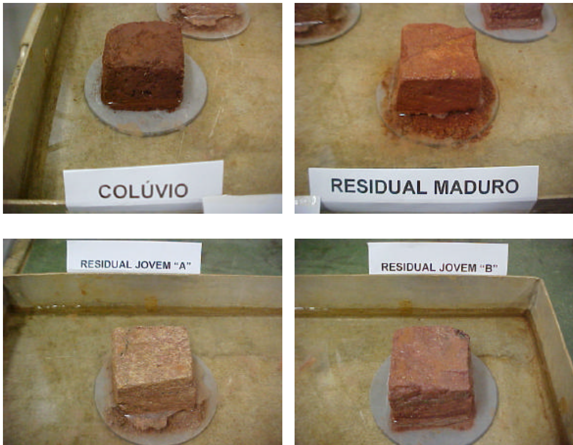
Figura 5.16 – Amostras colocadas sobre Pedra Porosa, Ensaio de Imersão Progressiva (até a 1/3 H – 45 min)
