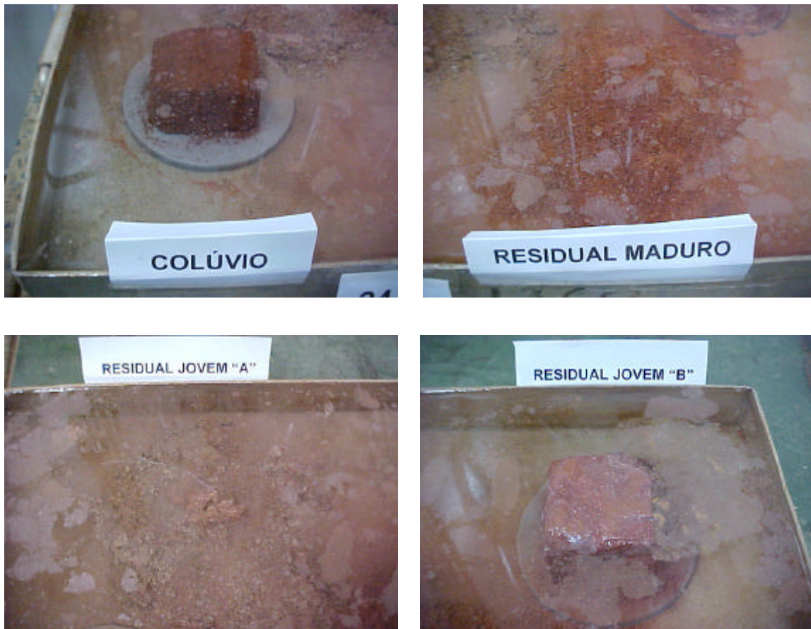
Figura 5.18 – Amostras colocadas sobre Pedra Porosa, Ensaio de Imersão Total (período de 24 horas)
