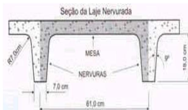
Figura 1.4 – Representação da laje nervurada [9].
