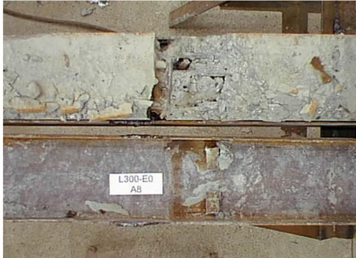
Figuras 4.19– Detalhe do segundo par de conectores do pilar L300-E0-A3.
