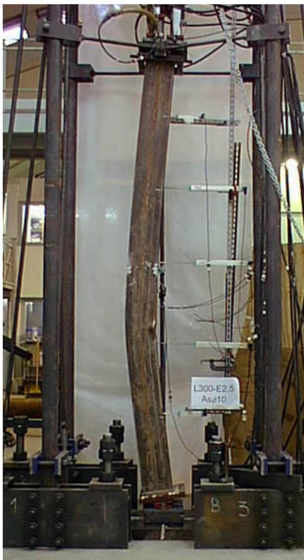
Figura 4.32 – Deformação final do pilar L300-E2.5-A4.8.
