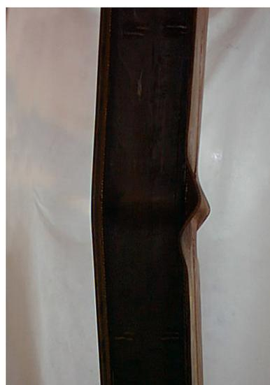
Figuras 4.11 e 4.12 – Detalhe frontal e lateral do pilar L300-E0-A0 deformado.
