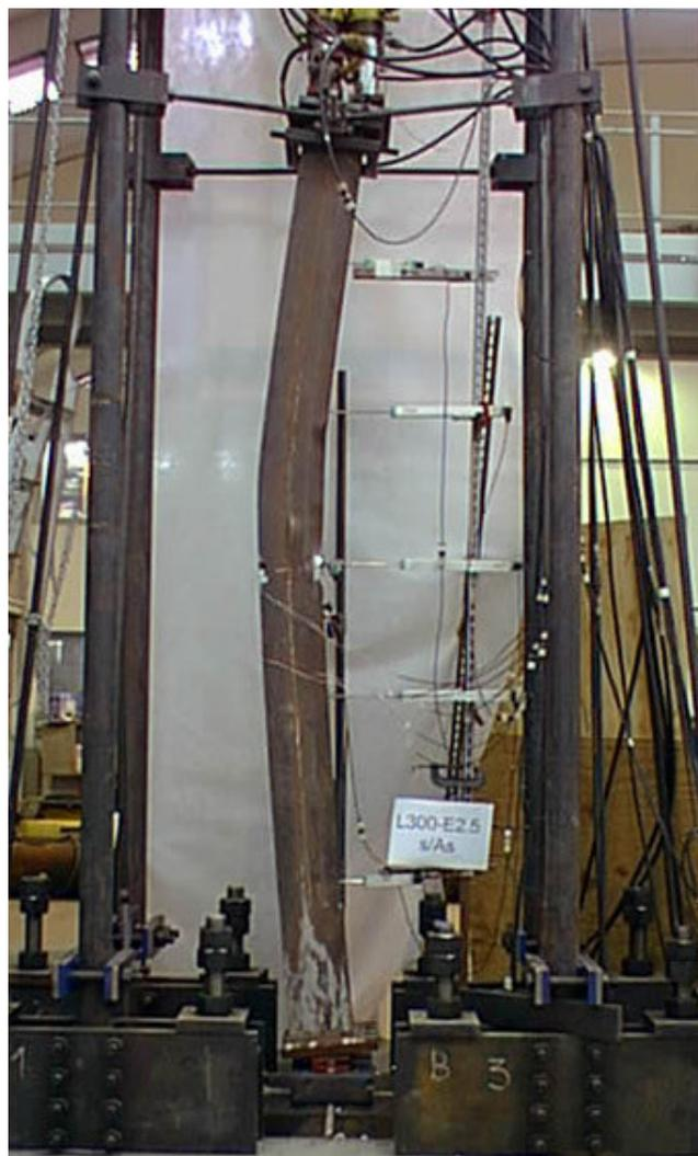
Figura 4.25 – Deformação final do pilar L300-E2.5-A0.
