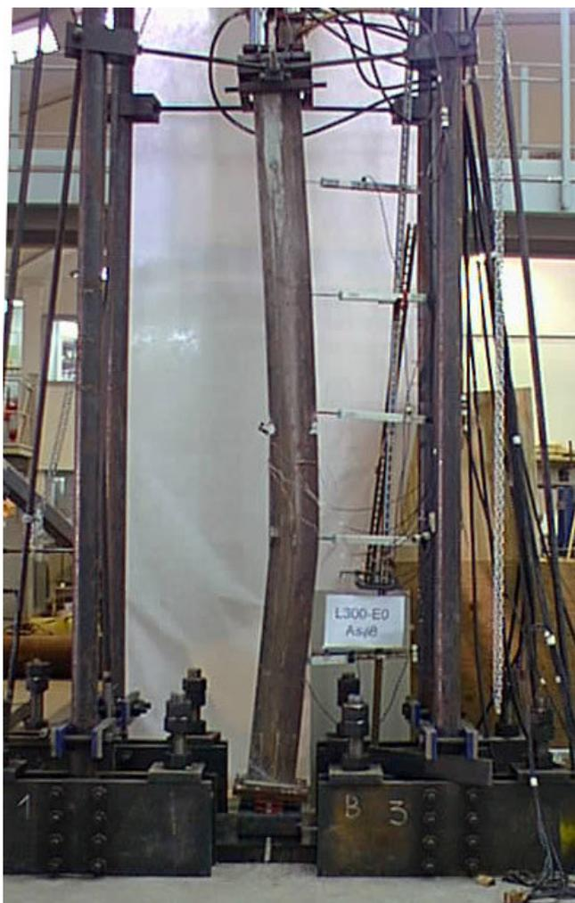
Figura 4.14 – Deformação final do pilar L300-E0-A3.
