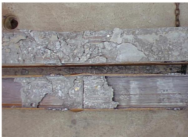
Figura 4.57 – Detalhe do local da ruptura no pilar L150-E5.
