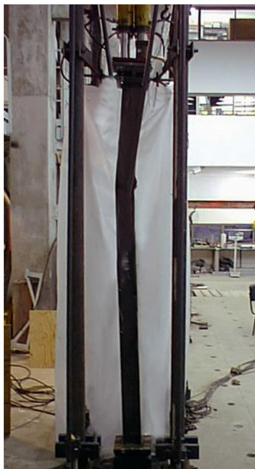
Figuras 4.9 e 4.10 – Vista frontal e lateral do pilar L300-E0-A0 deformado.
