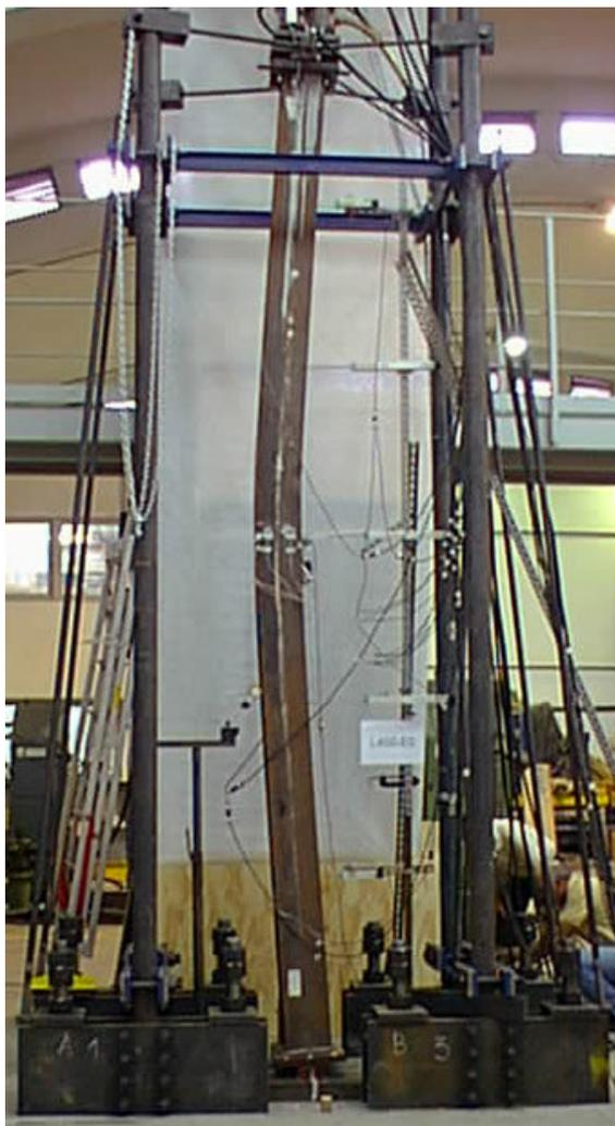
Figura 4.2 – Deformação final do pilar L450-E0.
