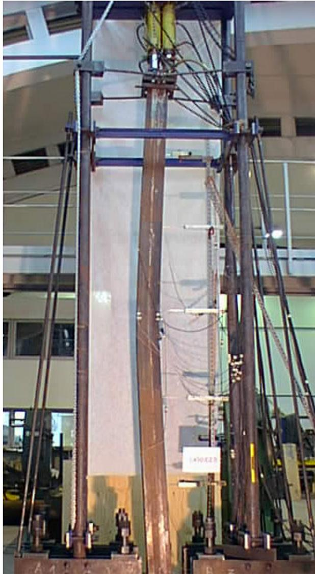
Figura 4.4 – Deformação final do pilar L450-E2.5.
