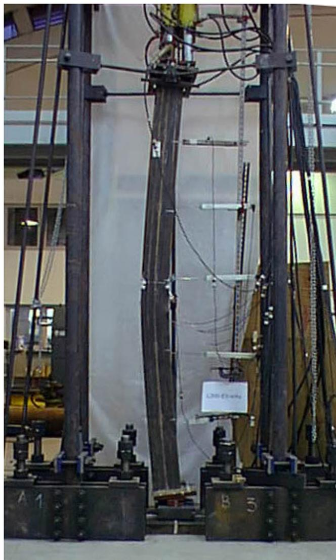
Figura 4.37 – Deformação final do pilar L300-E5-A0.
