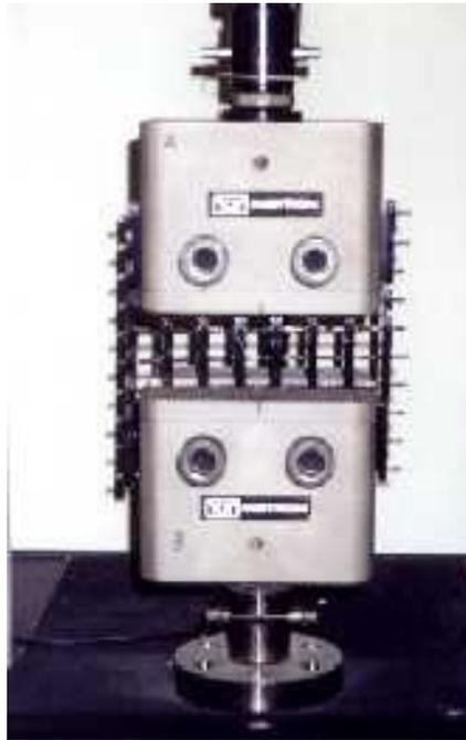
Figura 40 - Equipamento de Tração Simples - Geogrelhas Poliméricas
