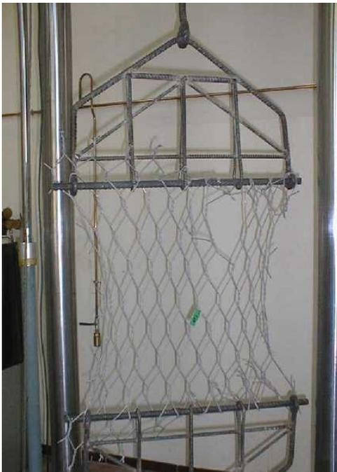
(c) Ruptura da Malha
