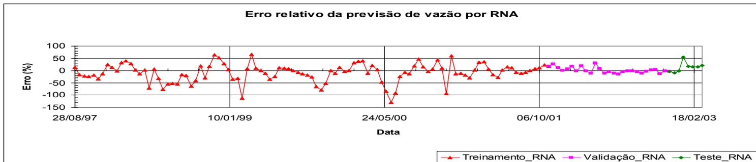
Figura 5.4 Erro relativo da vazão com a rede neural RNA I para os conjuntos de treinamento, validação e teste.
