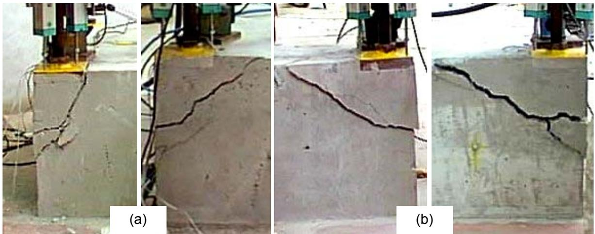
Figura 4.43 - Ruptura em placas de canto.
