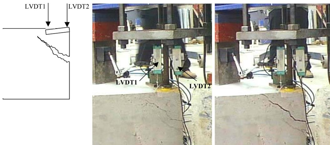
Figura 4.18 - Influência do posicionamento nas medidas de deslocamento para os ensaios de pino único de canto com armadura de suspensão.
