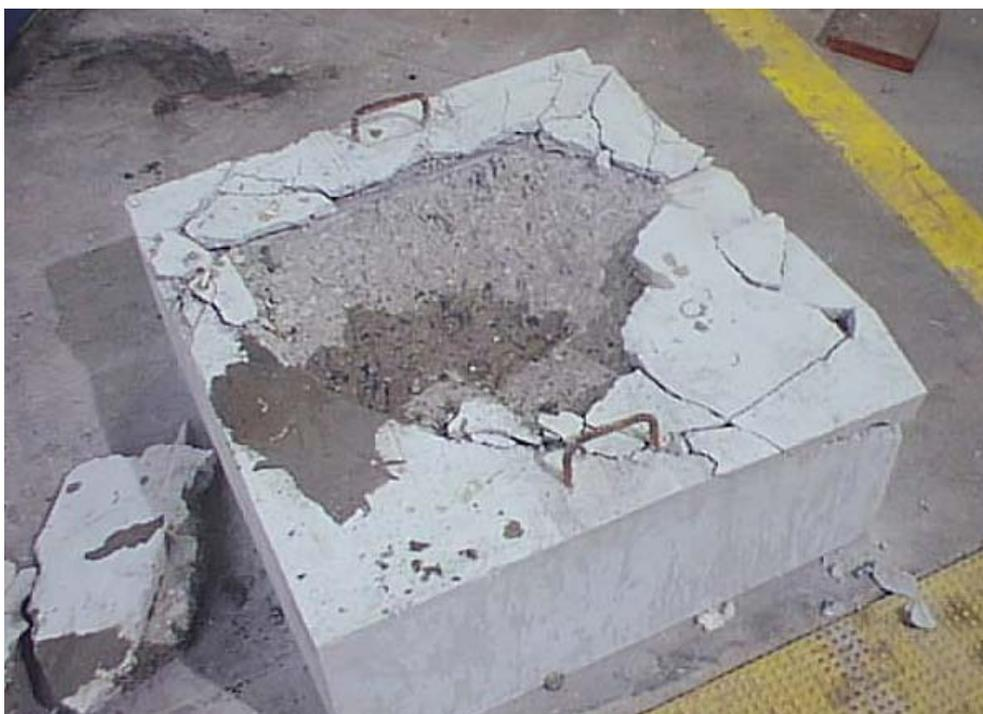
Figura 4.41 - Superfície de ruptura irregular do ensaio de placa de quatro pinos isolada.
