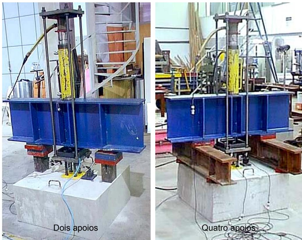
Figura 3.22 - Arranjo experimental para placas de quatro pinos.
