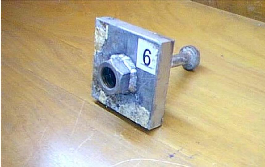
Figura 3.12 - Porca soldada na placa para permitir a introdução do carregamento.
