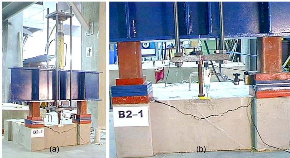
Figura 3.19 - Arranjo experimental e forma da ruptura de placa de pino único de bordo.
