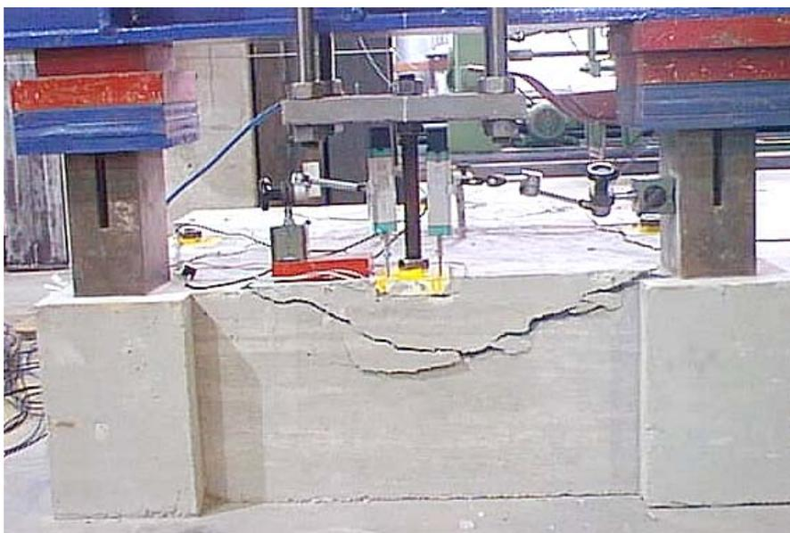
Figura 3.20 - Ruptura de placa de pino único de bordo com armadura de suspensão.
