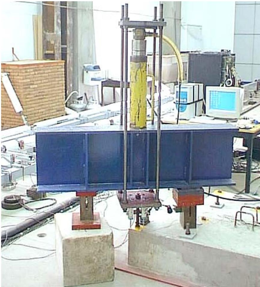
Figura 3.21 - Arranjo experimental para placa de pino único de canto.
