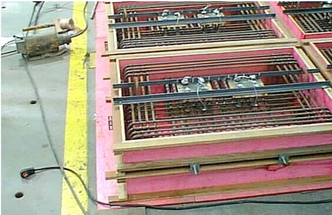
Figura 3.13 - Posicionamento das placas de ancoragem para um bloco tipo B4.
