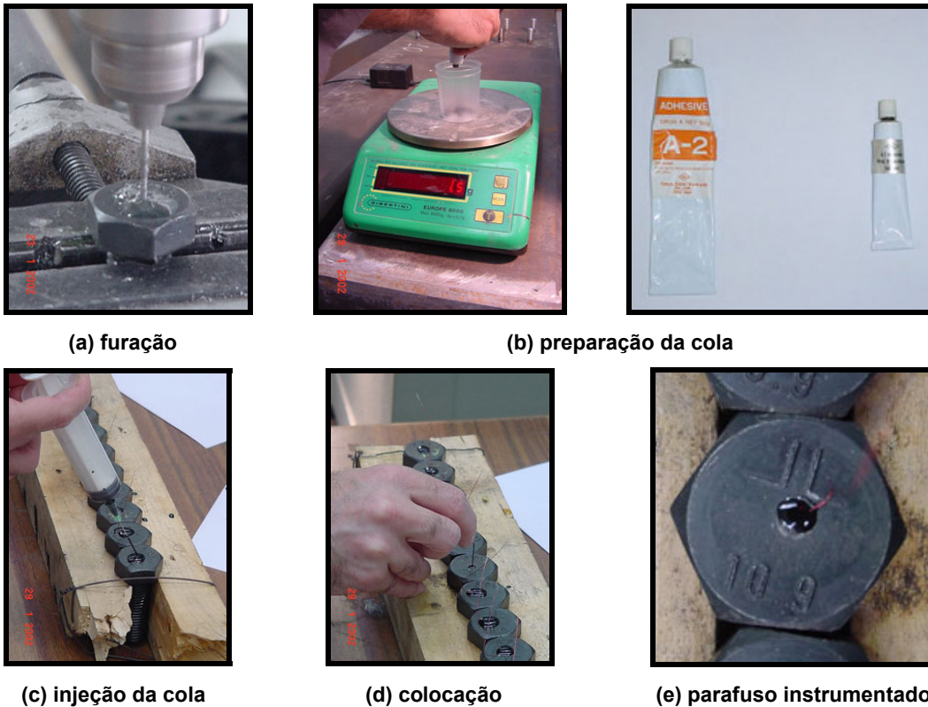
Figura 3.15 – Instrumentação dos parafusos
