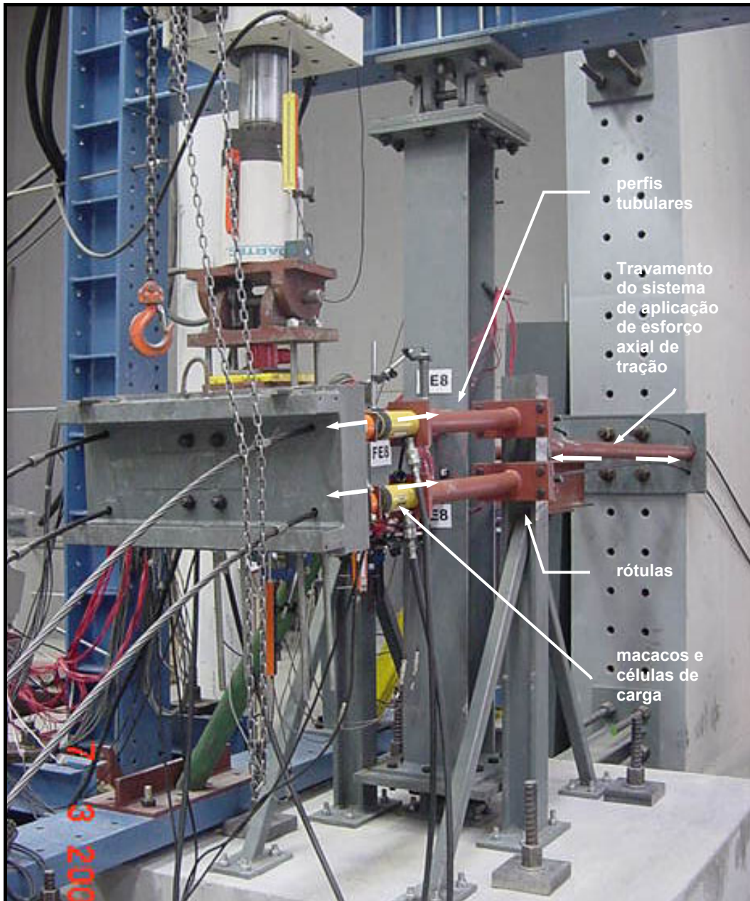
Figura 3.12 – Sistema de aplicação de esforço axial de tração
