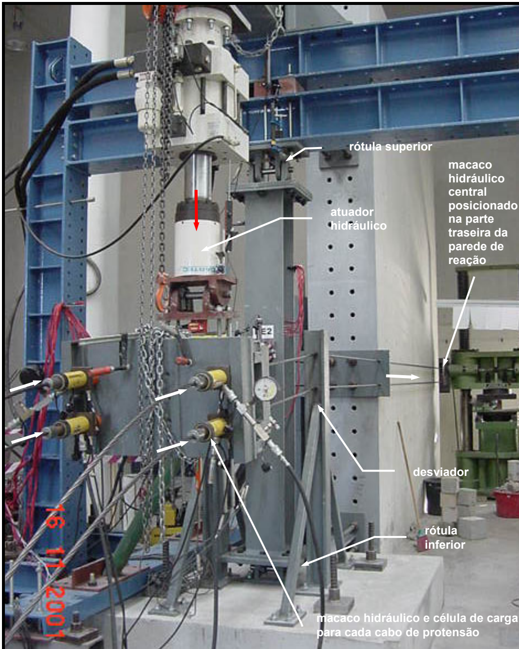
Figura 3.8 – Sistema de aplicação de esforço axial de compressão
