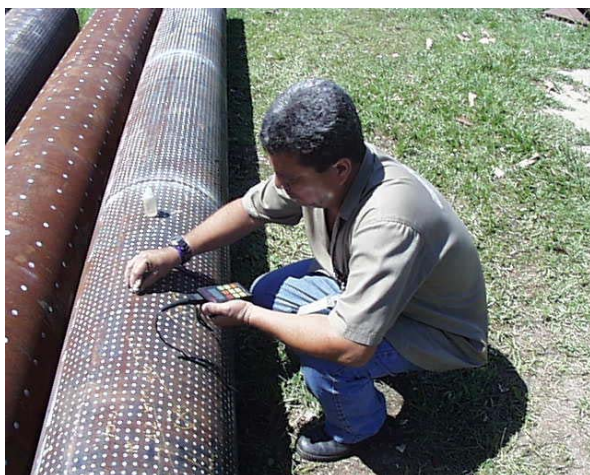
Figura 7 - Medição manual por ultra-som
