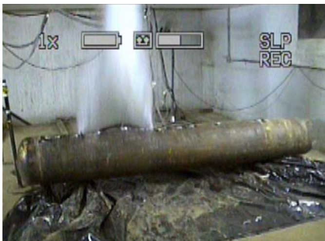
Figura 10 – Espécime T04 no instante da ruptura
