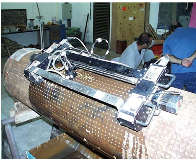
Figura 8 - Medição mecanizada por ultra-som
