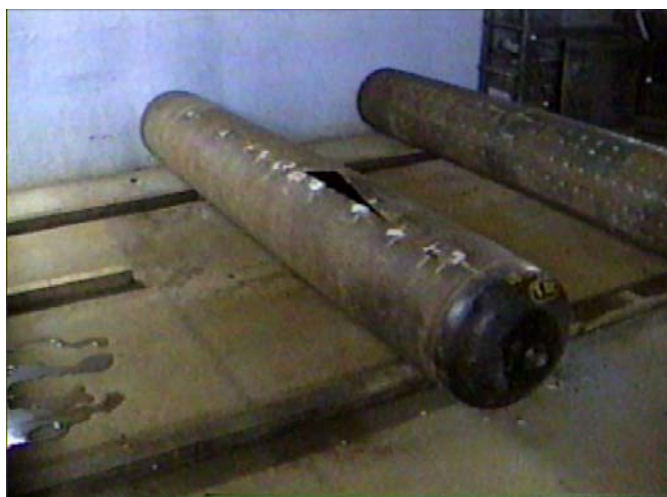
Figura 11 – Espécime T04 após a ruptura
