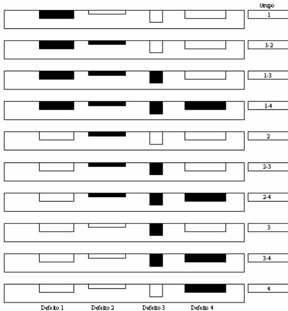
Figura 6 - Exemplo de agrupamento de defeitos adjacentes para interação
