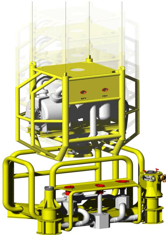
Fig. 3.40 Unidade de Bombeamento Submarino (*subsea pump unit*)
