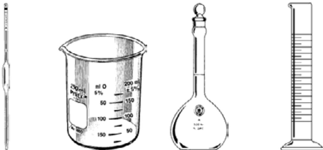
*Pipeta volumétrica, béquer, balão volumétrico e proveta são algumas das vidrarias usadas na preparação de soluções.*
