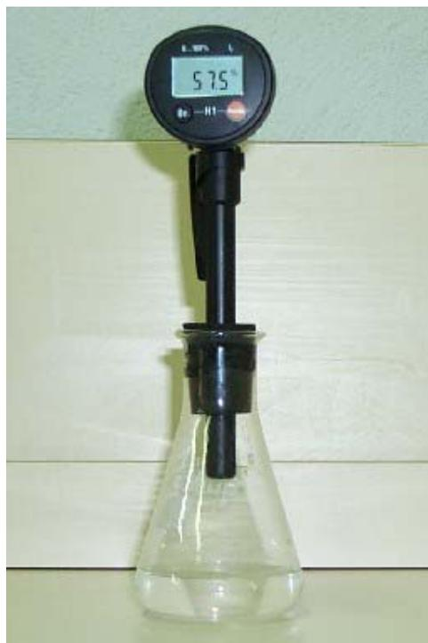
Figura 6. 32 – Ensaio para obter a atividade química de soluções
