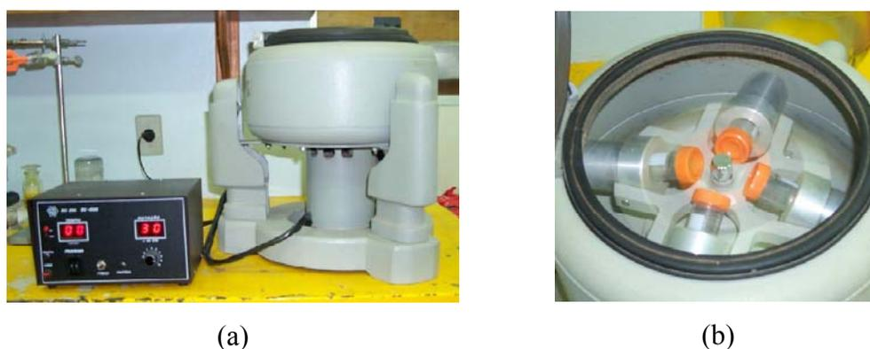
Figura 6. 4 – Centrífuga para separação das fases líquida e sólida
