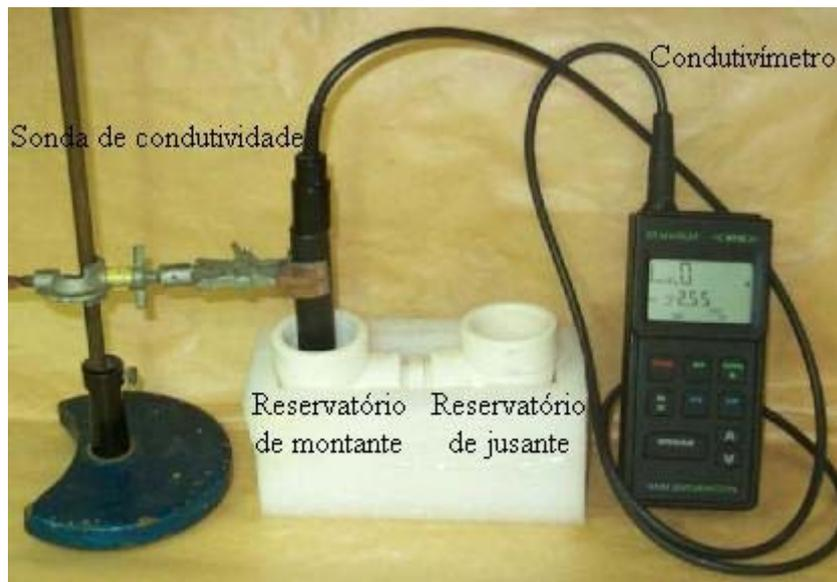
Figura 5. 10 – Esquema do equipamento utilizado no ensaio de difusão em solo residual
