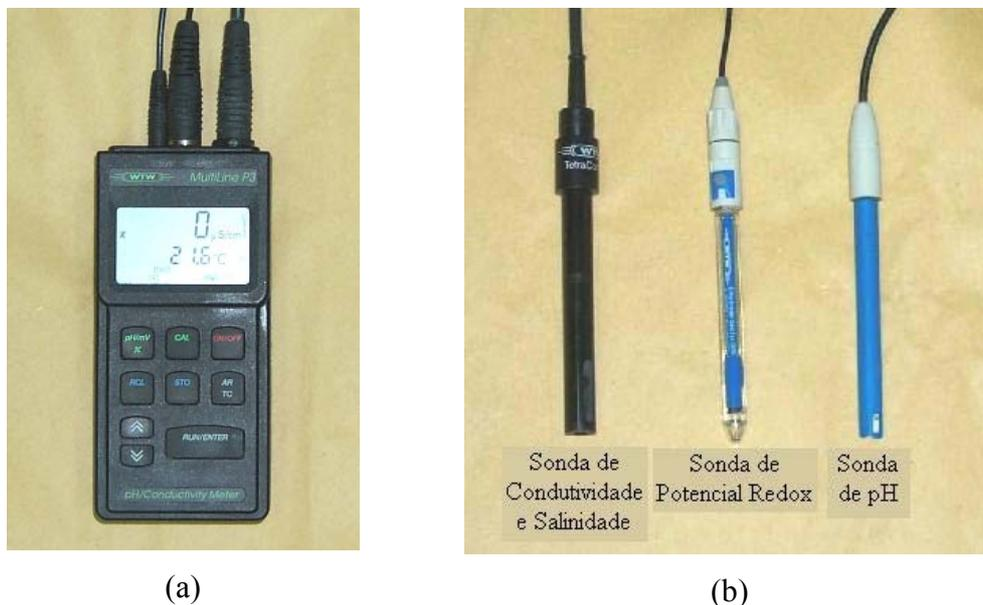
Figura 5. 1 – (a) Leitora de dados eletroquímicos e (b) Sondas utilizadas
