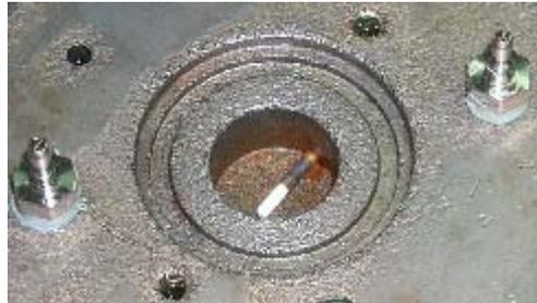
Figura 5. 6 – Novo sensor utilizado no reservatório inferior
