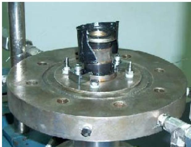
Figura 3. 21 – Retirada do CP27 da célula de difusão
