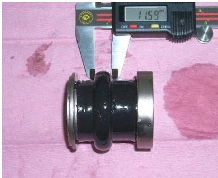
Figura 3. 17 – Corpo de prova 26 após o ensaio de difusão
