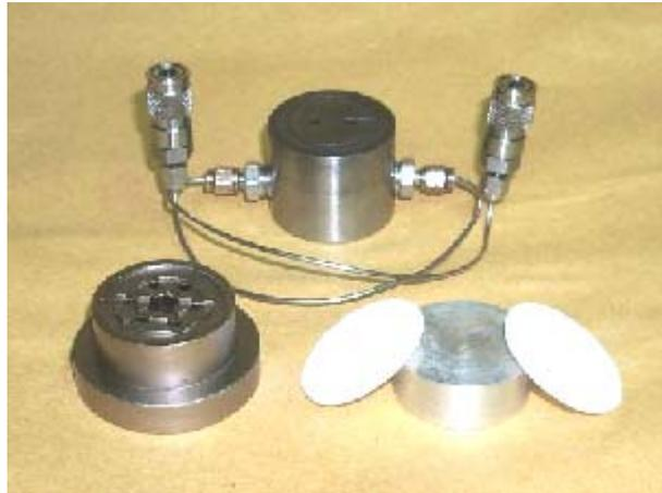
Figura 3. 24 – Detalhe do novo “cap” maciço e das pedras porosas de plástico
