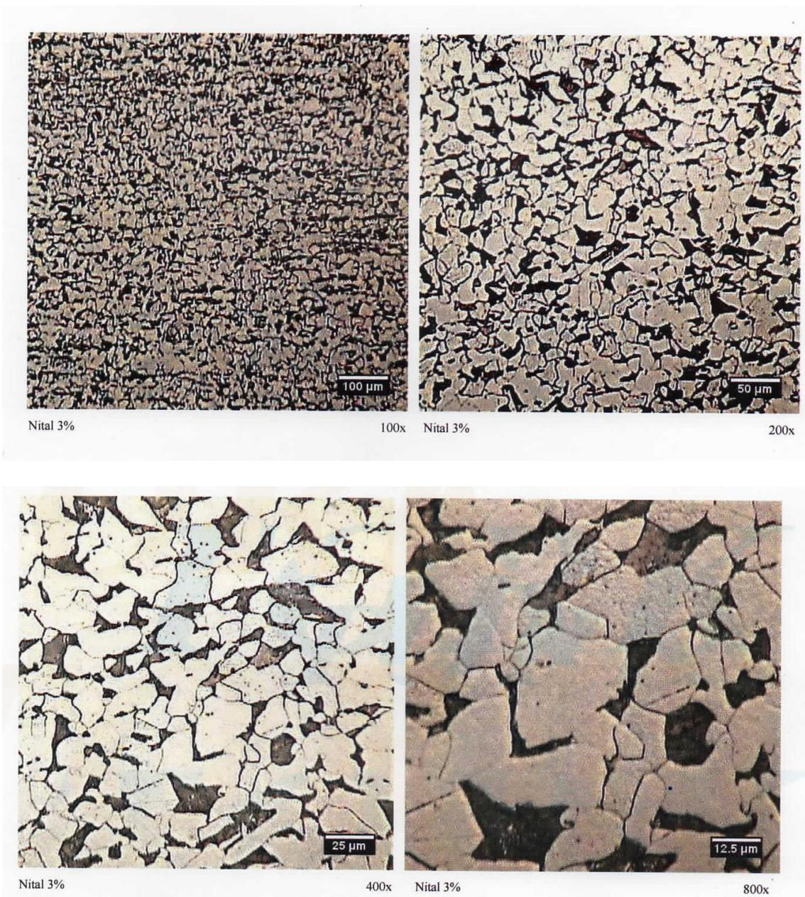
Figura I.6 – Micrografia do aço AISI 1020
