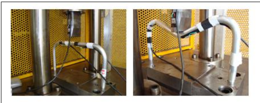
Figura 123 (a) Estrutura de teste instrumentada antes e depois da colisão. Laboratório de Ensaios Mecânicos da NUCLEP – Nuclebrás Equipamentos Pesados S.A.
