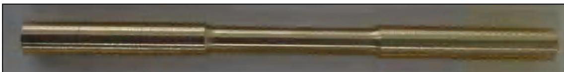
Figura 3 - Corpo de prova padrão fabricado numa máquina CNC.
