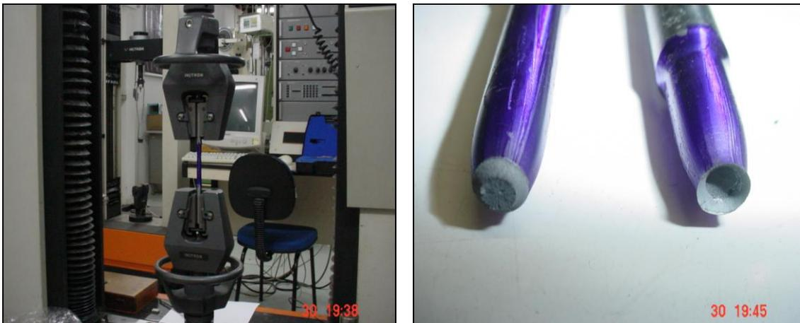
Figura 6 – Máquina Instron 5500 R e o CP de tração com uma bela fratura copo-cone.
