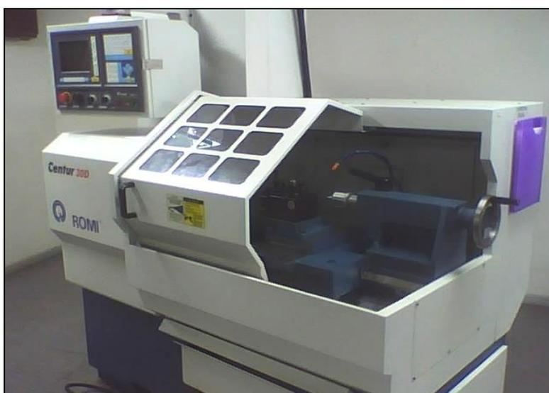
Figura 4 - Máquina CNC usada para fabricar os CP testados neste trabalho.
