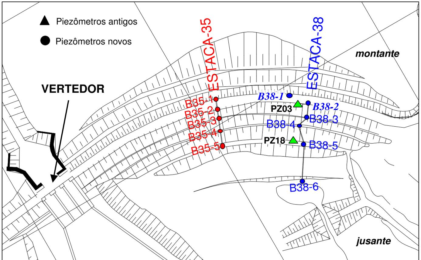
Figura 77 - Posicionamento em planta dos piezômetros
