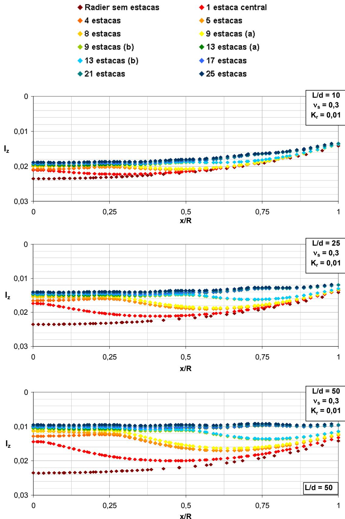
Figura A1. 10 – Efeito do arranjo das estacas e  $L/d$  na deflexão do radier ( $v_s = 0,3$ ,  $K_r = 0,01$ , seção A-A).
