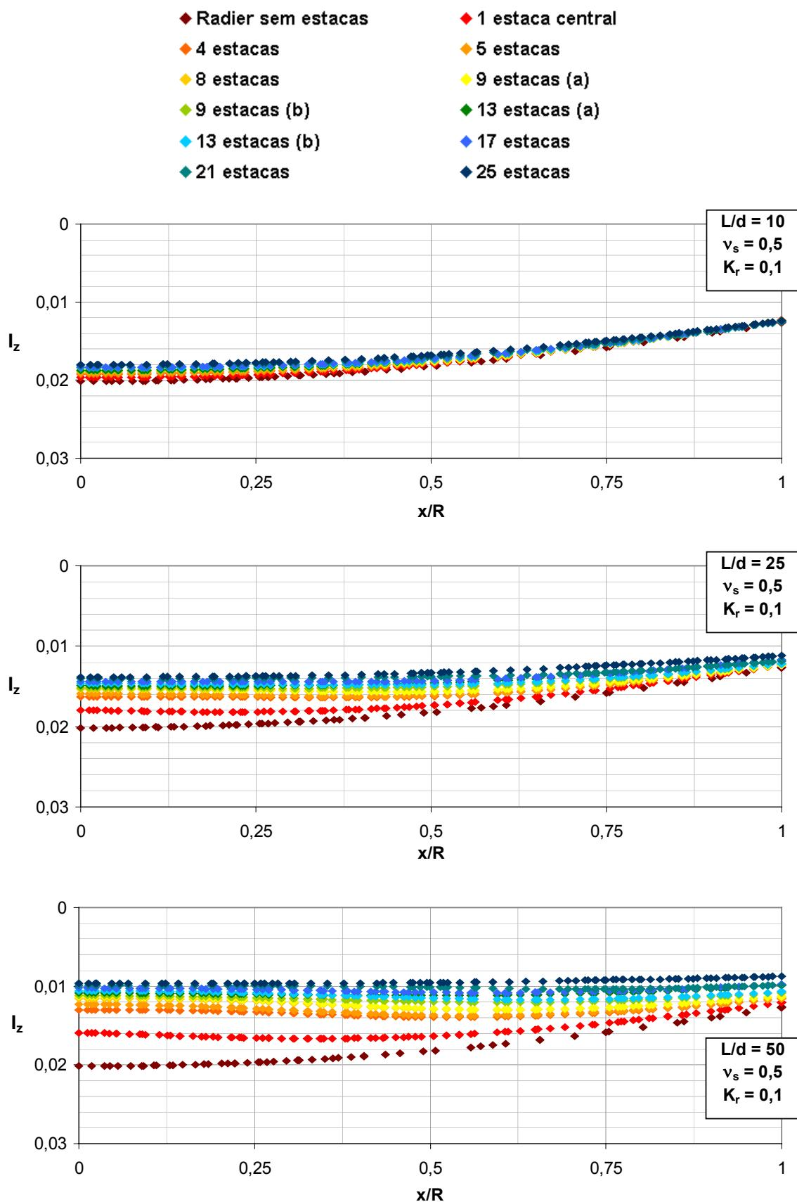
Figura A1. 23 – Efeito do arranjo das estacas e  $L/d$  na deflexão do radier ( $v_s = 0,5$ ,  $K_r = 0,1$ , seção B-B).
