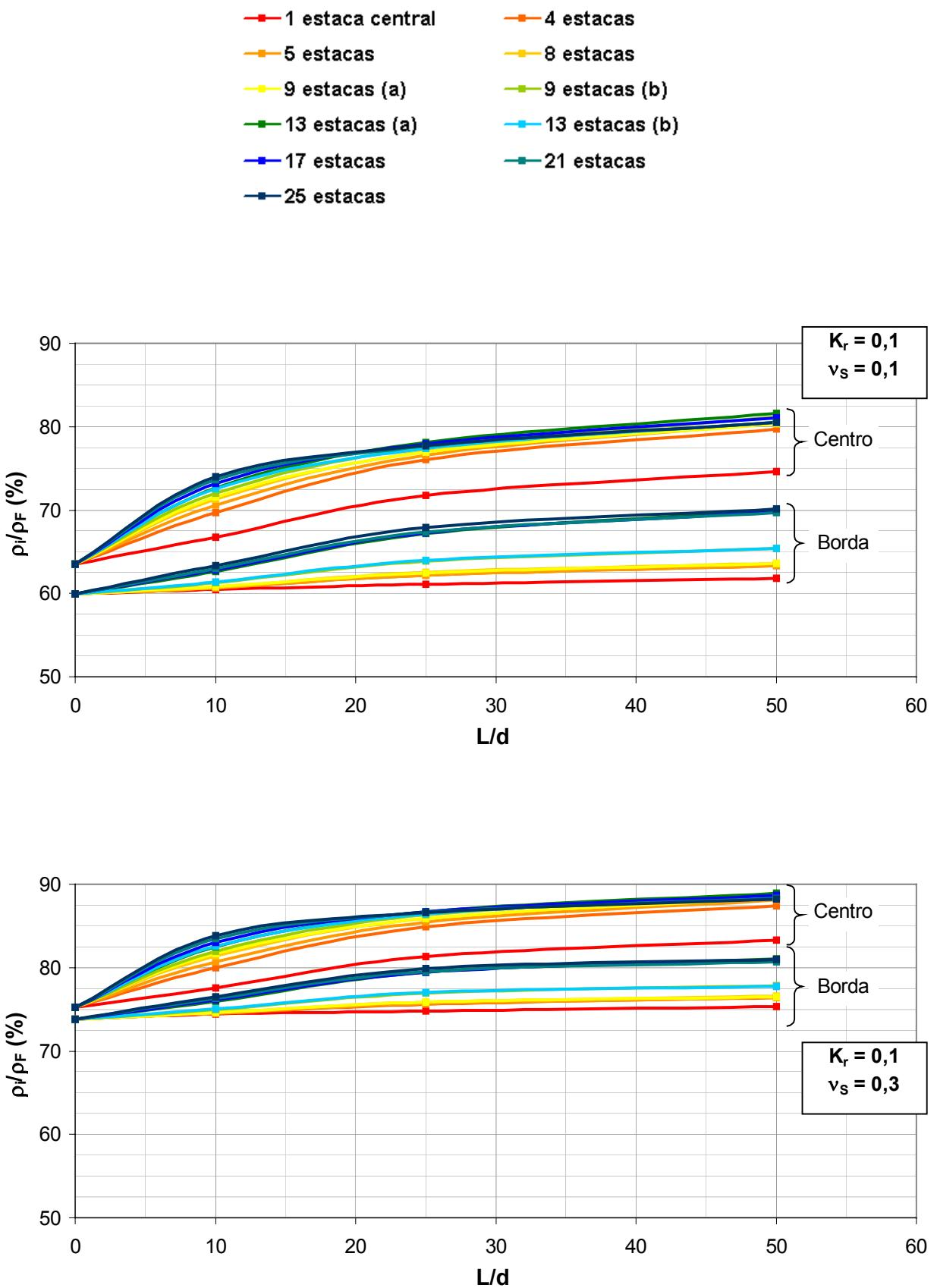
Figura A2. 2 – Recalque imediato  $\rho_i$  vs. recalque final  $\rho_F$  para  $K_r = 0,1$ .
