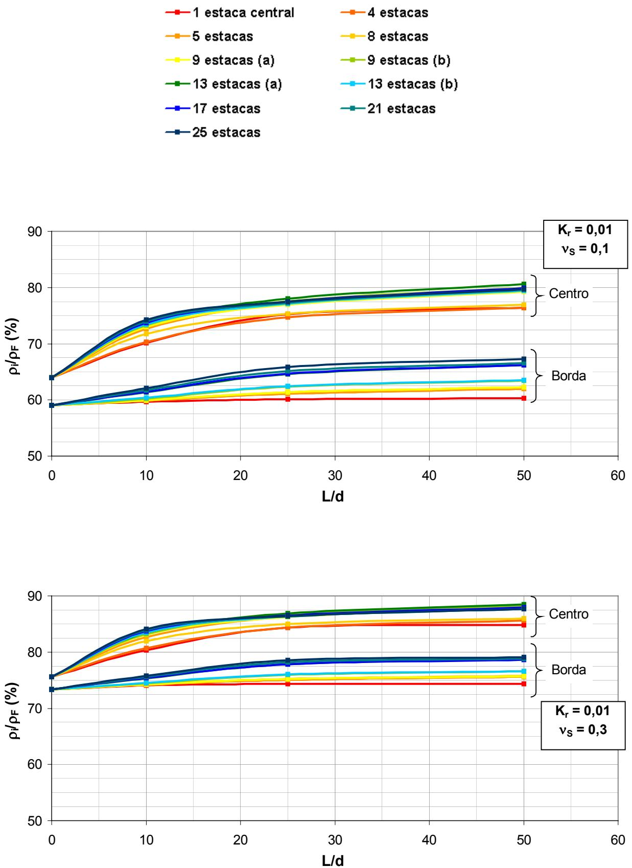
Figura A2. 1 – Recalque imediato  $\rho_i$  vs. recalque final  $\rho_F$  para  $K_r = 0,01$ .
