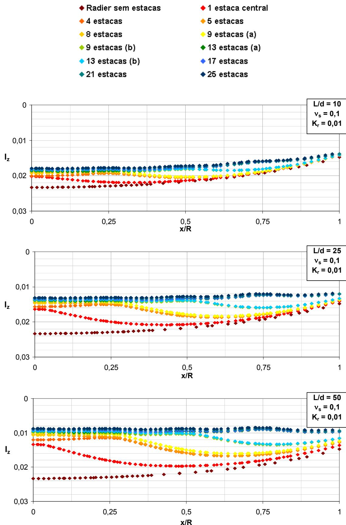
Figura A1. 1 – Efeito do arranjo das estacas e  $L/d$  na deflexão do radier ( $v_s = 0,1$ ,  $K_r = 0,01$ , seção A-A).
