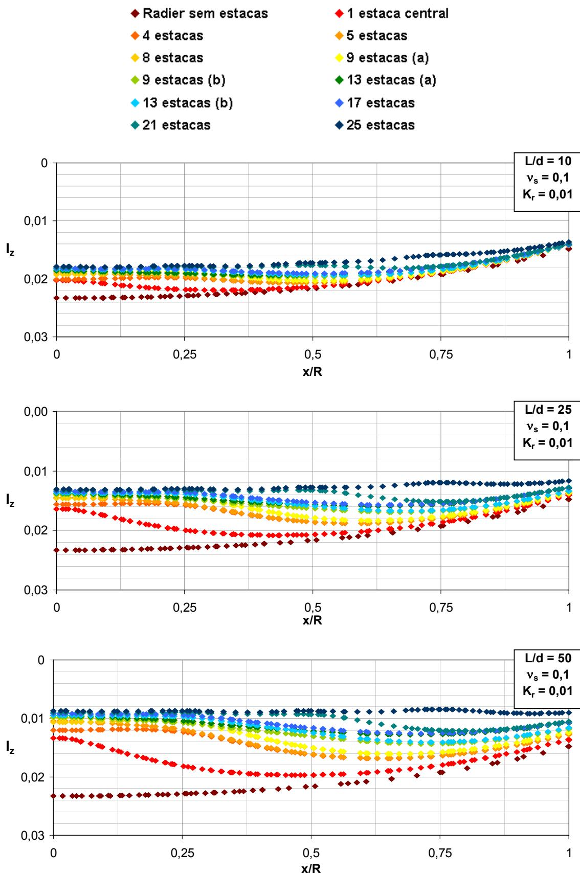
Figura A1. 2 – Efeito do arranjo das estacas e  $L/d$  na deflexão do radier ( $v_s = 0,1$ ,  $K_r = 0,01$ , seção B-B).
