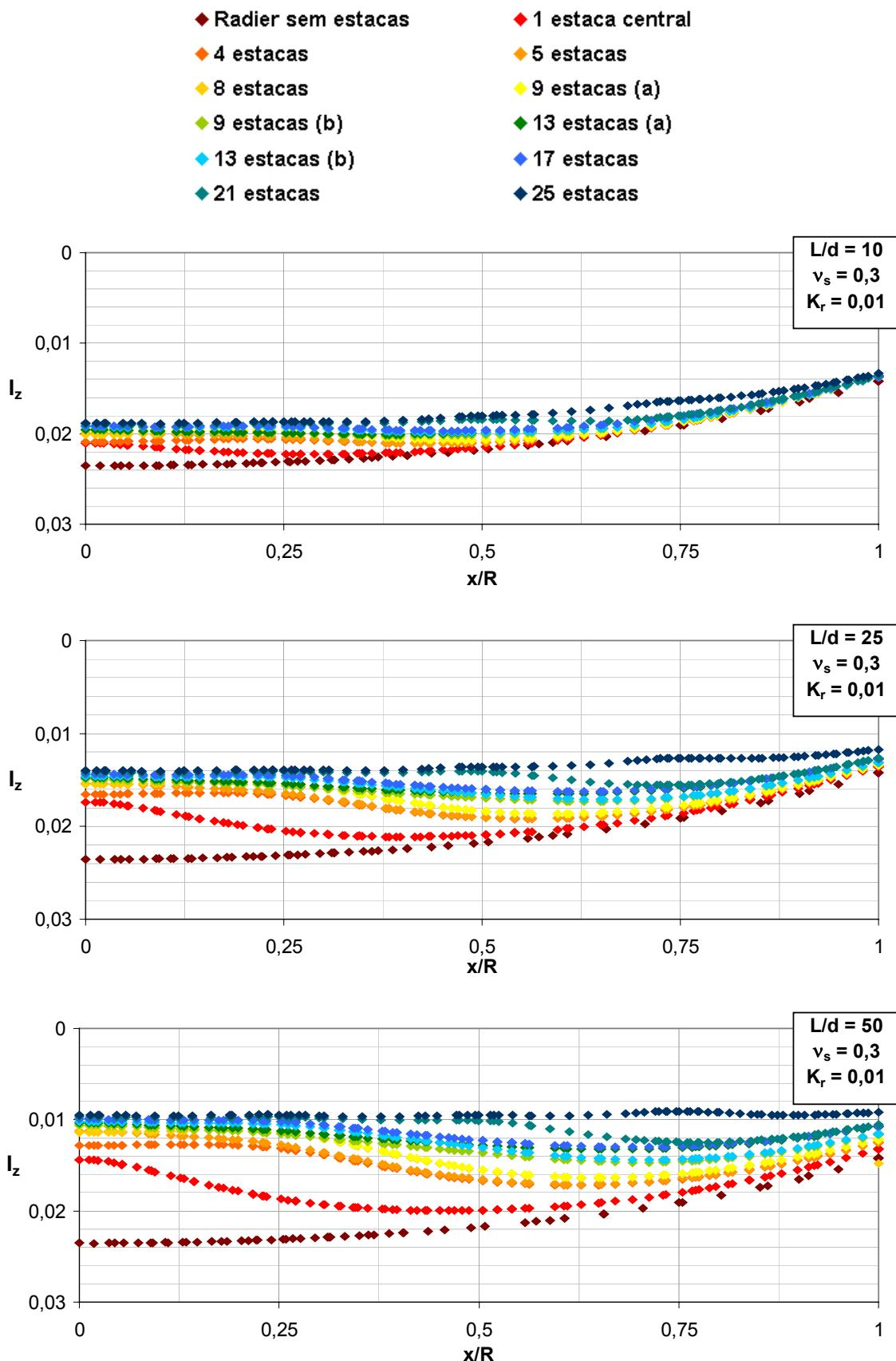
Figura A1. 11 – Efeito do arranjo das estacas e  $L/d$  na deflexão do radier ( $v_s = 0,3$ ,  $K_r = 0,01$ , seção B-B).
