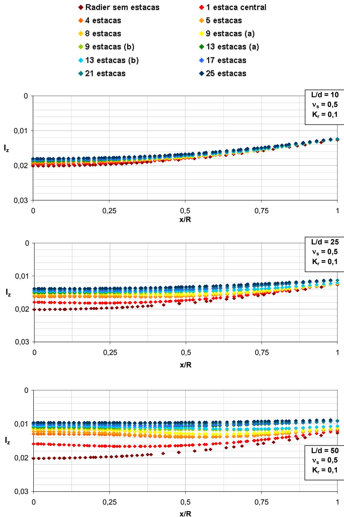
Figura A1. 22 – Efeito do arranjo das estacas e  $L/d$  na deflexão do radier ( $v_s = 0,5$ ,  $K_r = 0,1$ , seção A-A).
