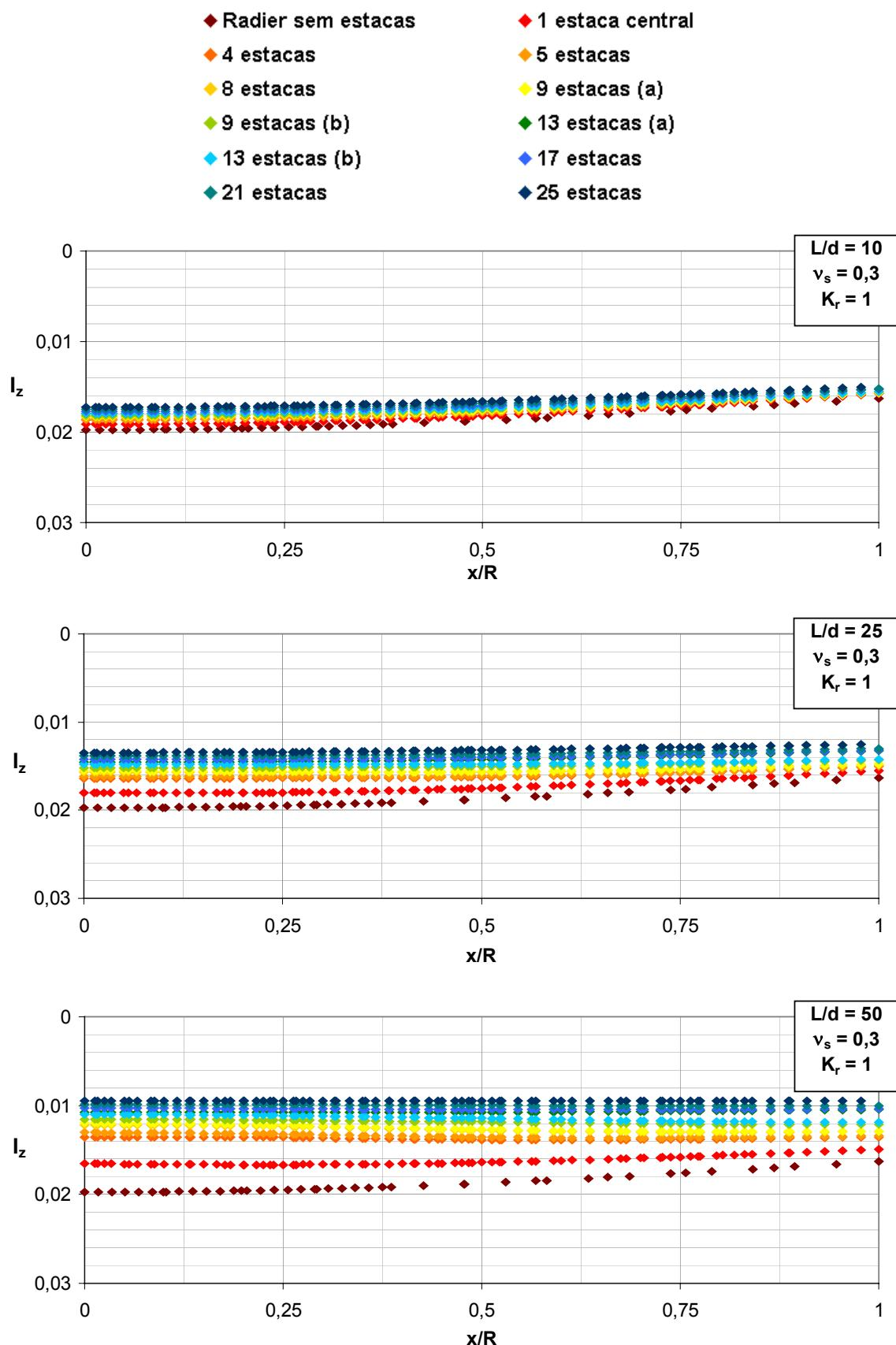
Figura A1. 16 – Efeito do arranjo das estacas e  $L/d$  na deflexão do radier ( $v_s = 0,3$ ,  $K_r = 1$ , seção A-A).
