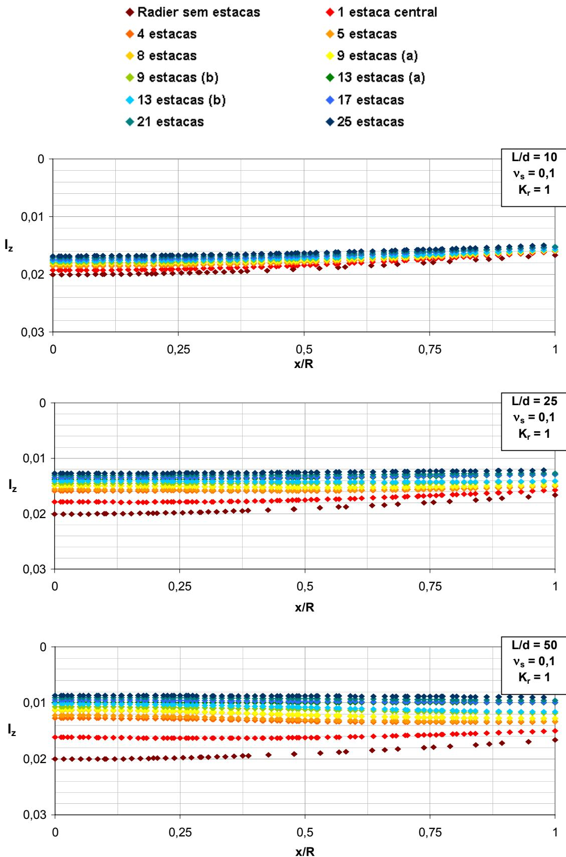
Figura A1. 7 – Efeito do arranjo das estacas e  $L/d$  na deflexão do radier ( $v_s = 0,1$ ,  $K_r = 1$ , seção A-A).
