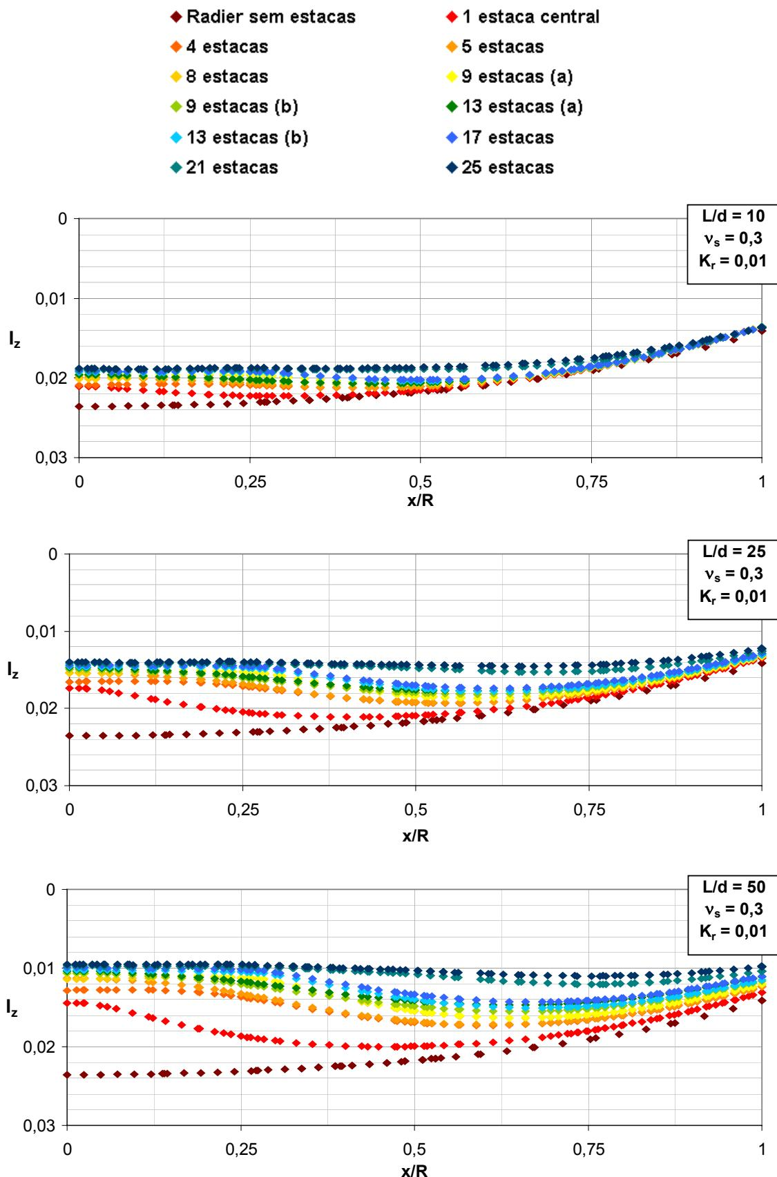
Figura A1. 12 – Efeito do arranjo das estacas e  $L/d$  na deflexão do radier ( $v_s = 0,3$ ,  $K_r = 0,01$ , seção C-C).
