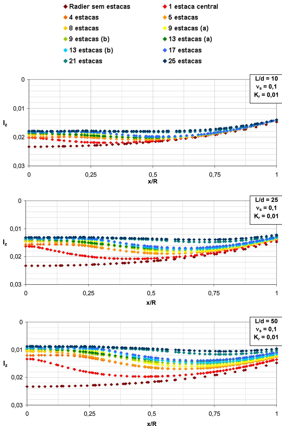
Figura A1. 3 – Efeito do arranjo das estacas e  $L/d$  na deflexão do radier ( $v_s = 0,1$ ,  $K_r = 0,01$ , seção C-C).
