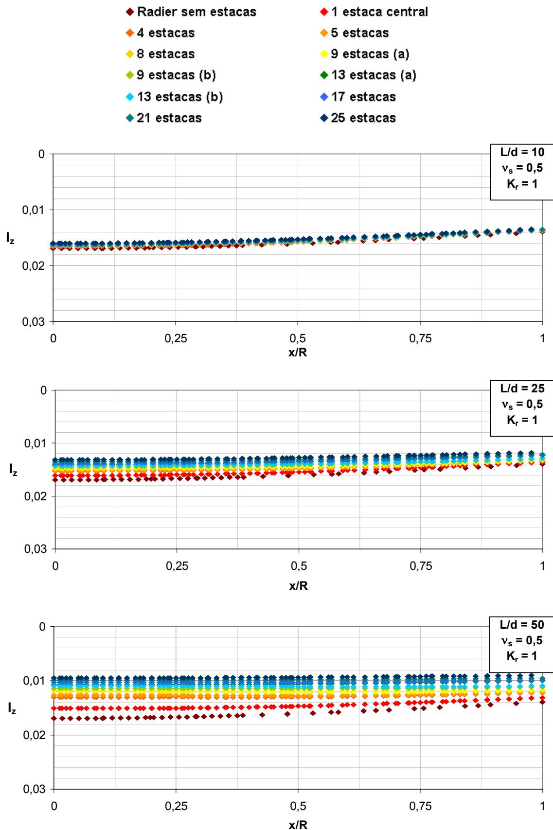
Figura A1. 25 – Efeito do arranjo das estacas e  $L/d$  na deflexão do radier ( $v_s = 0,5$ ,  $K_r = 1$ , seção A-A).
