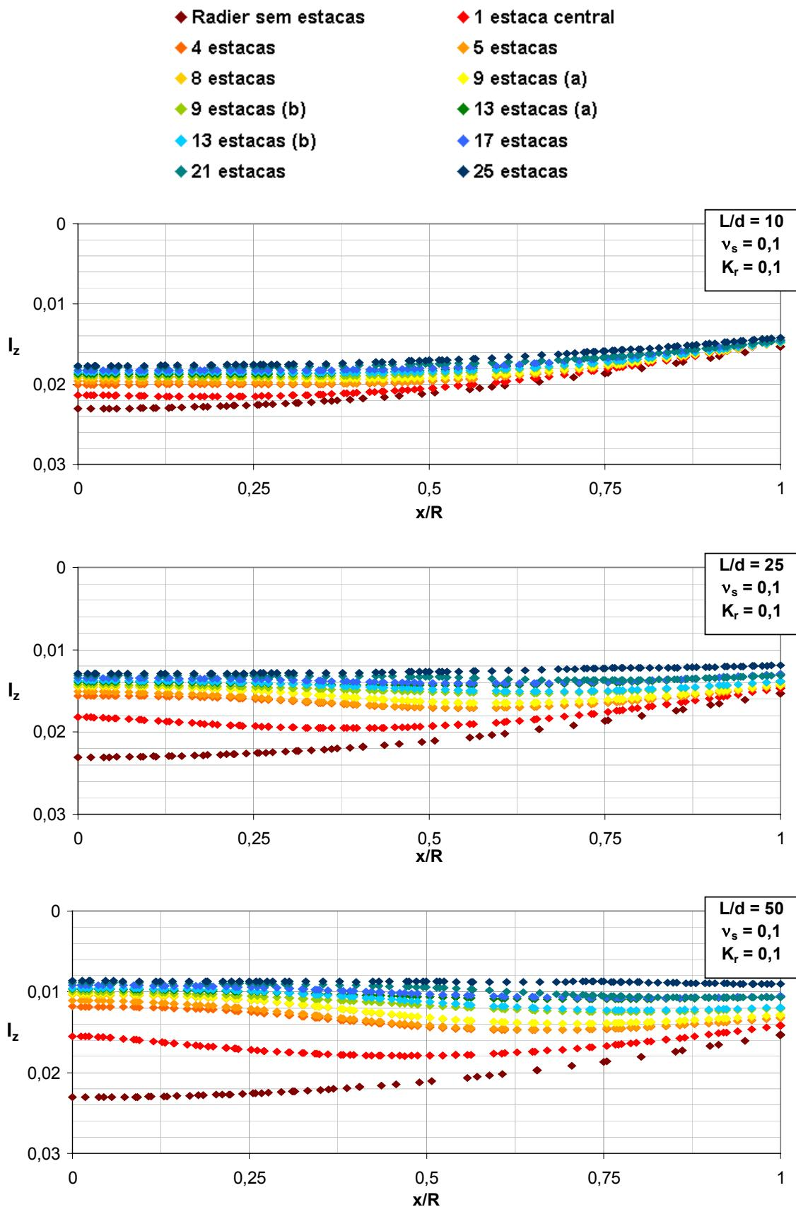
Figura A1. 5 – Efeito do arranjo das estacas e  $L/d$  na deflexão do radier ( $v_s = 0,1$ ,  $K_r = 0,1$ , seção B-B).
