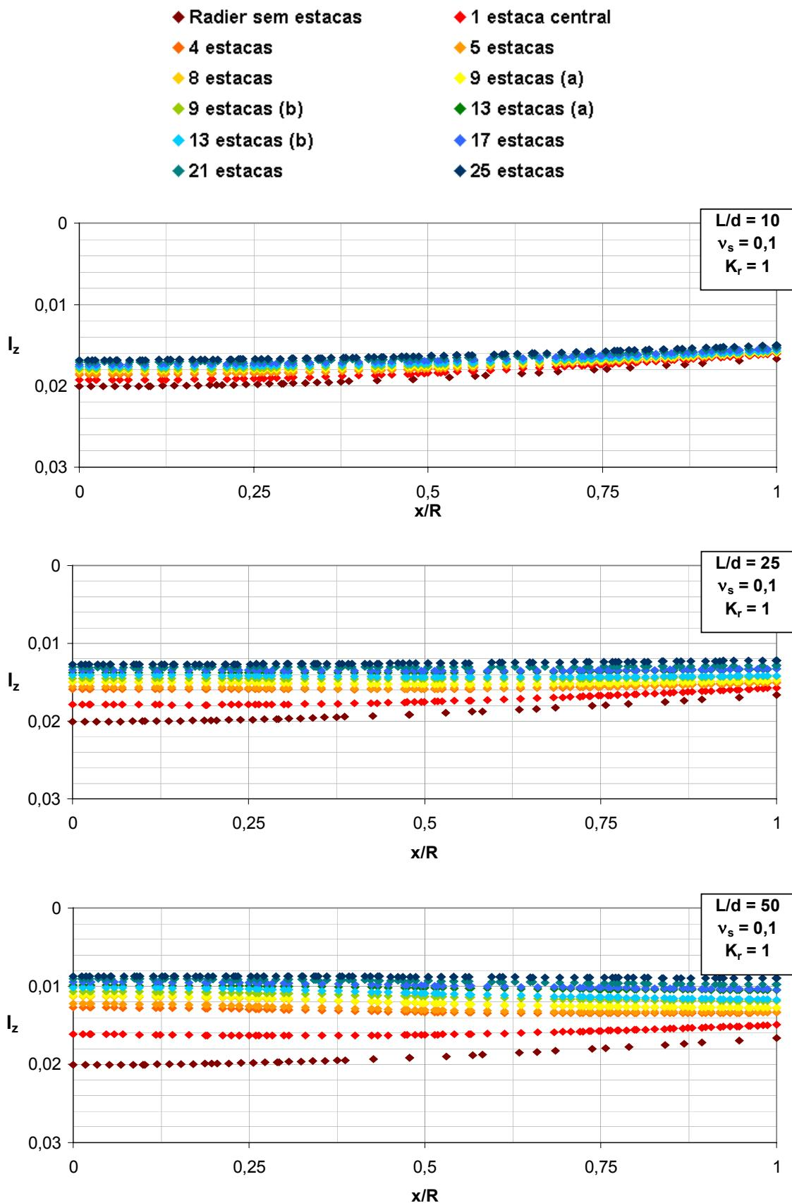
Figura A1. 9 – Efeito do arranjo das estacas e  $L/d$  na deflexão do radier ( $v_s = 0,1$ ,  $K_r = 1$ , seção C-C).
