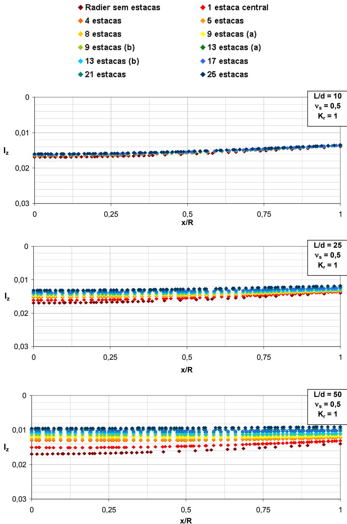
Figura A1. 27 – Efeito do arranjo das estacas e  $L/d$  na deflexão do radier ( $v_s = 0,5$ ,  $K_r = 1$ , seção C-C).
