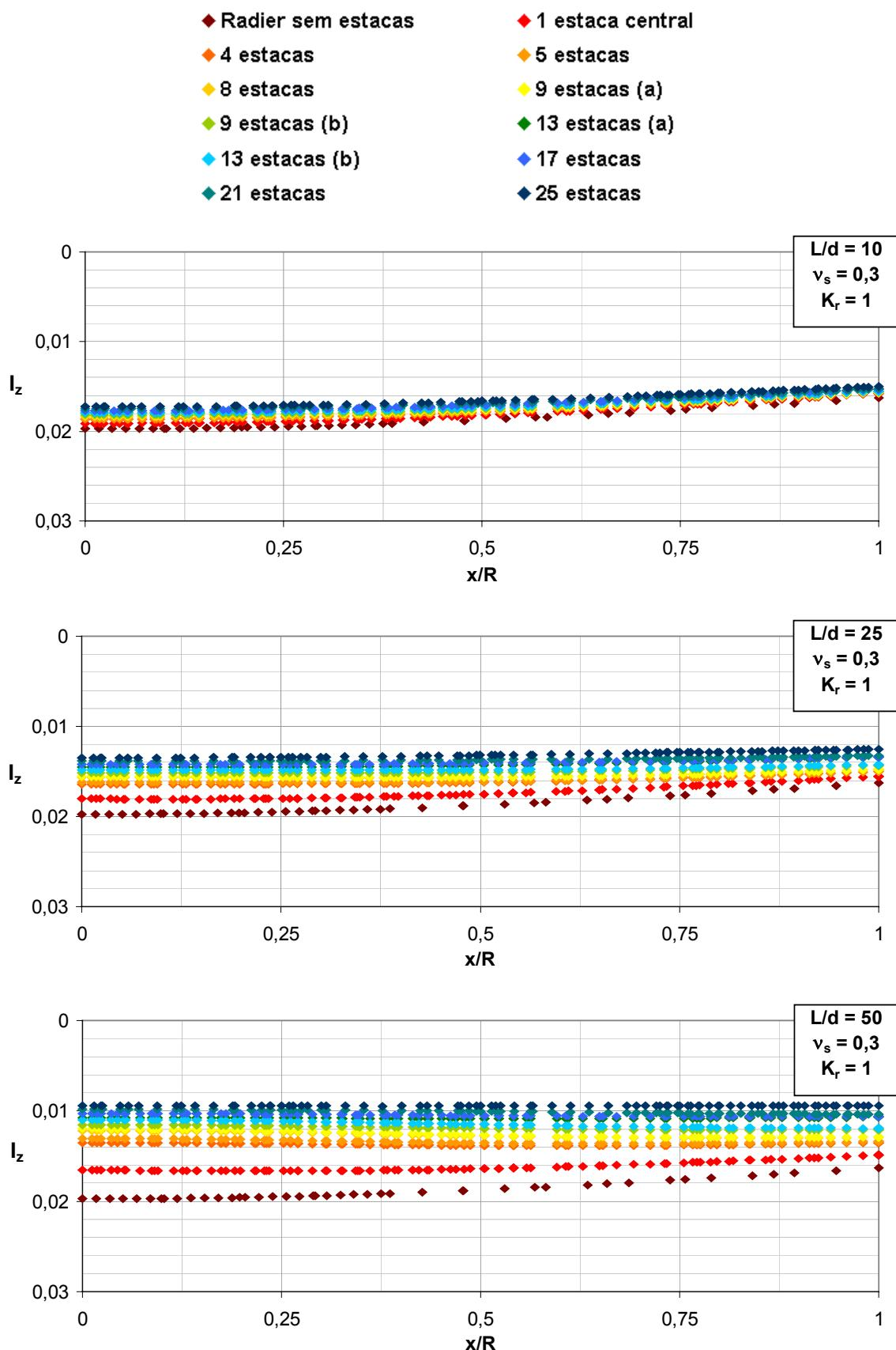
Figura A1. 17 – Efeito do arranjo das estacas e  $L/d$  na deflexão do radier ( $v_s = 0,3$ ,  $K_r = 1$ , seção B-B).
