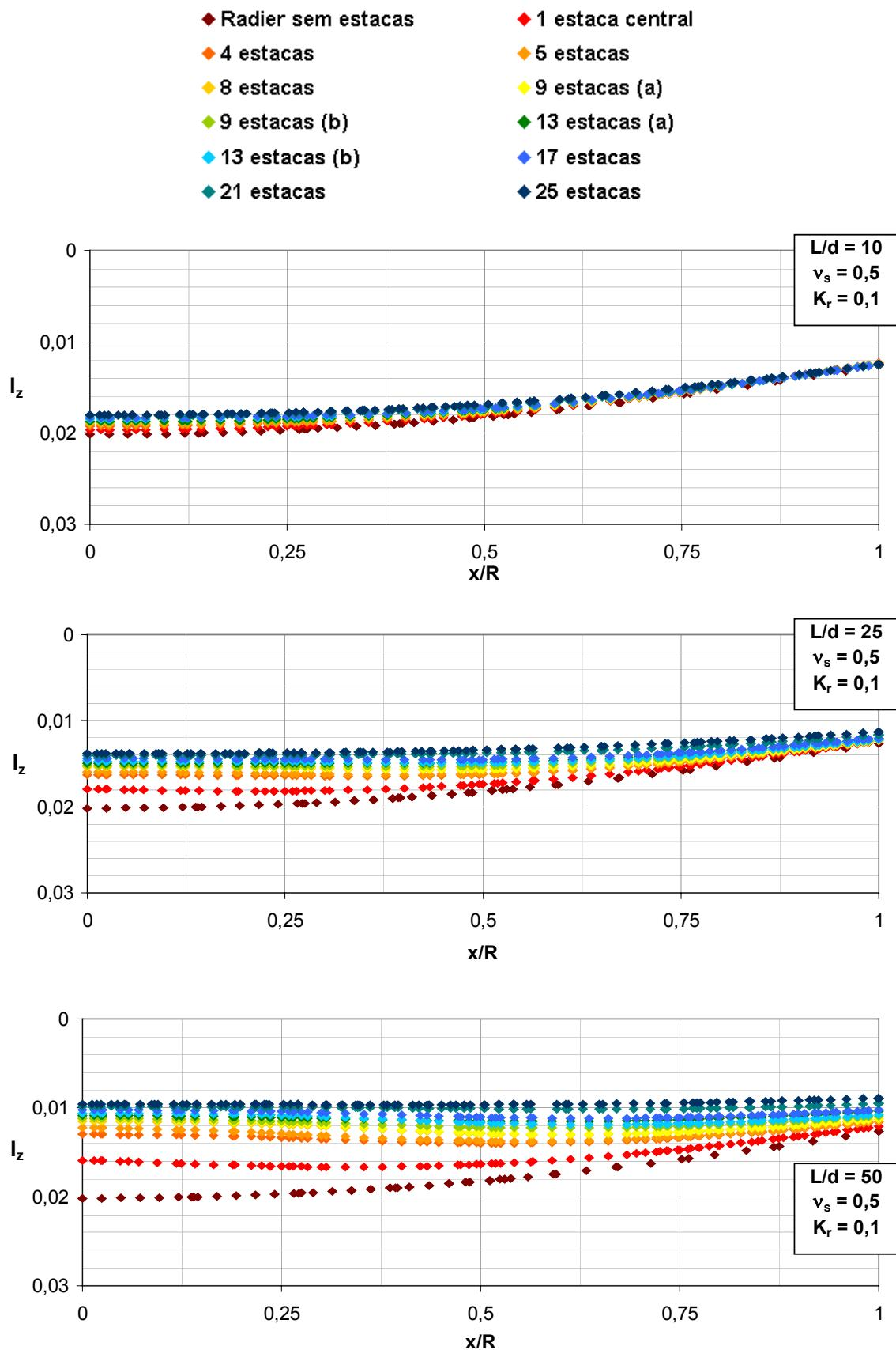
Figura A1. 24 – Efeito do arranjo das estacas e  $L/d$  na deflexão do radier ( $v_s = 0,5$ ,  $K_r = 0,1$ , seção C-C).
