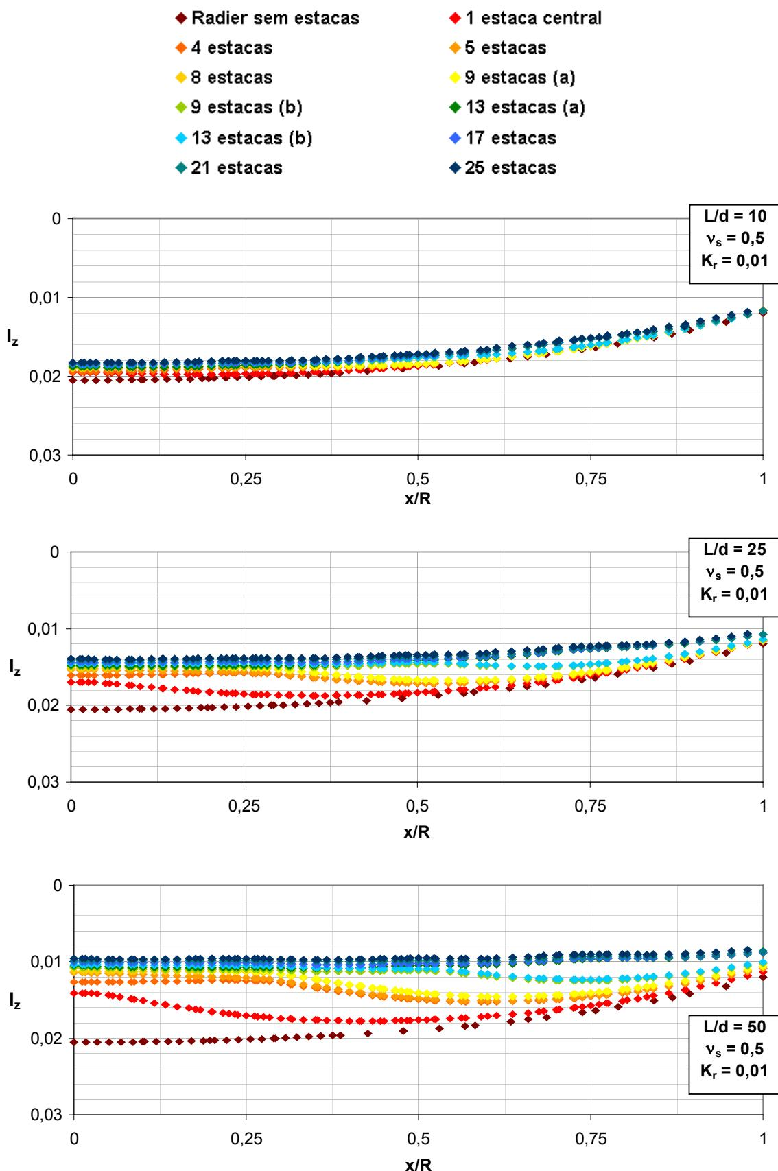
Figura A1. 19 – Efeito do arranjo das estacas e  $L/d$  na deflexão do radier ( $v_s = 0,5$ ,  $K_r = 0,01$ , seção A-A).
