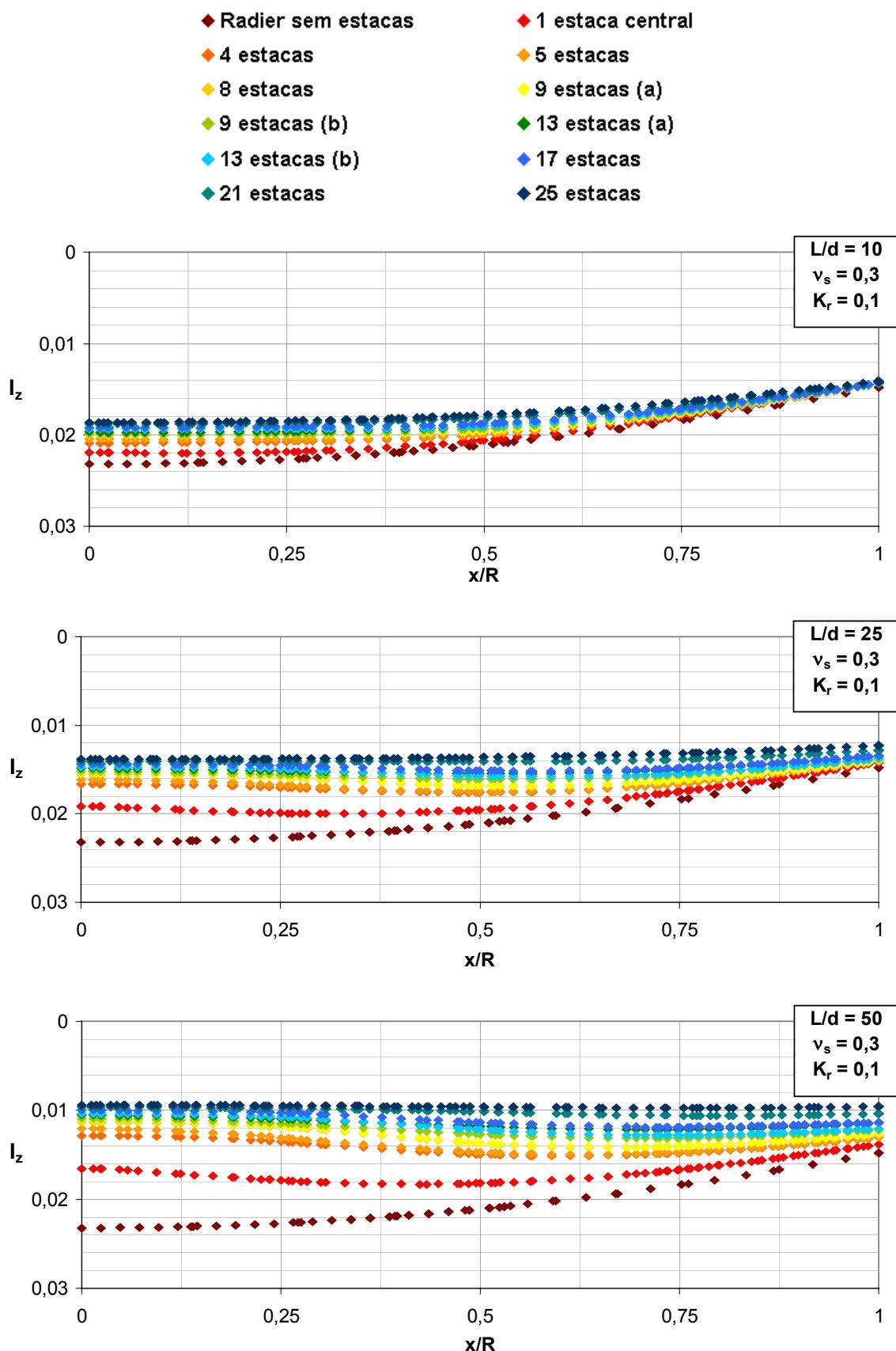
Figura A1. 15 – Efeito do arranjo das estacas e  $L/d$  na deflexão do radier ( $v_s = 0,3$ ,  $K_r = 0,1$ , seção C-C).
