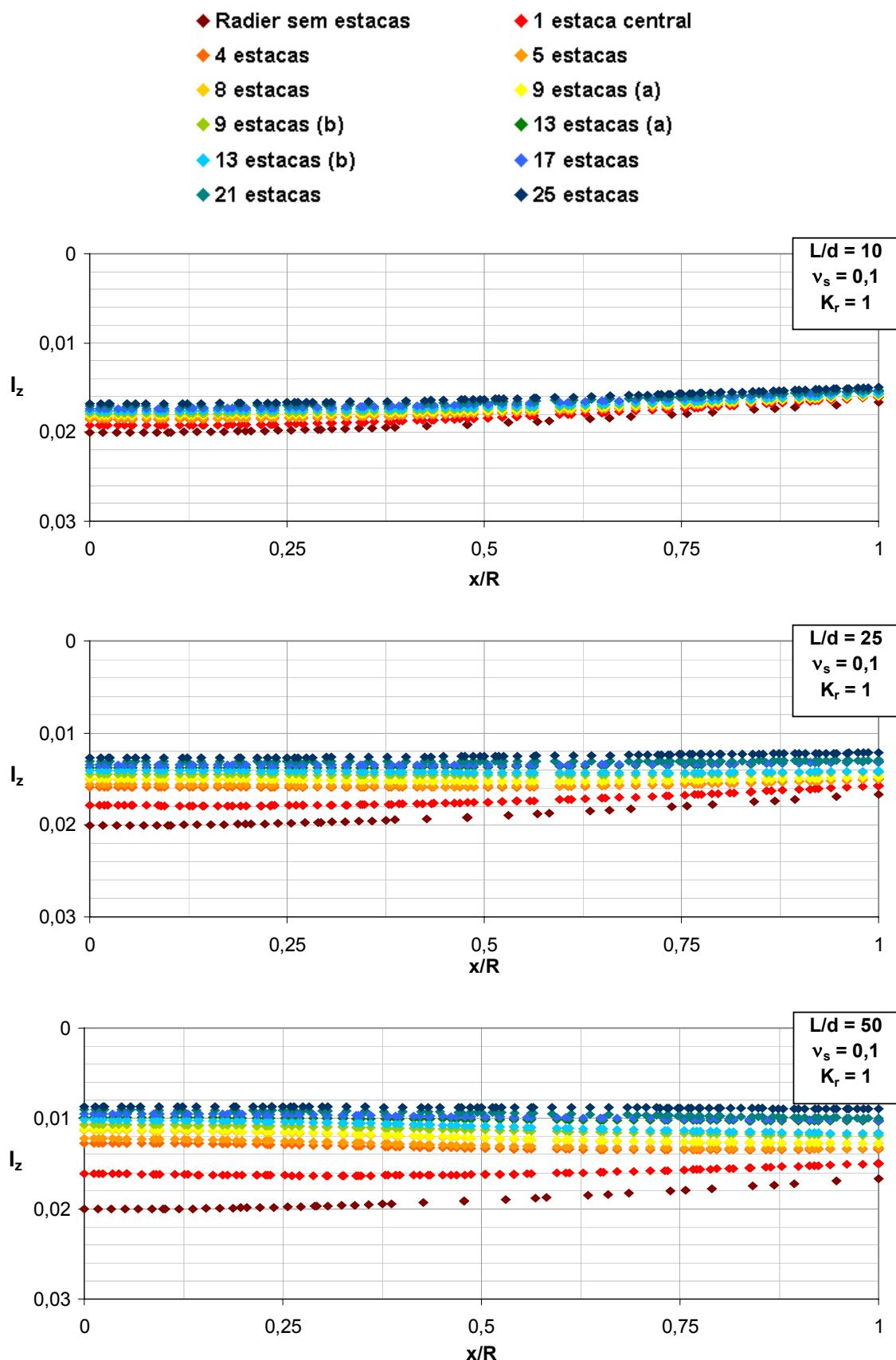
Figura A1. 8 – Efeito do arranjo das estacas e  $L/d$  na deflexão do radier ( $v_s = 0,1$ ,  $K_r = 1$ , seção B-B).
