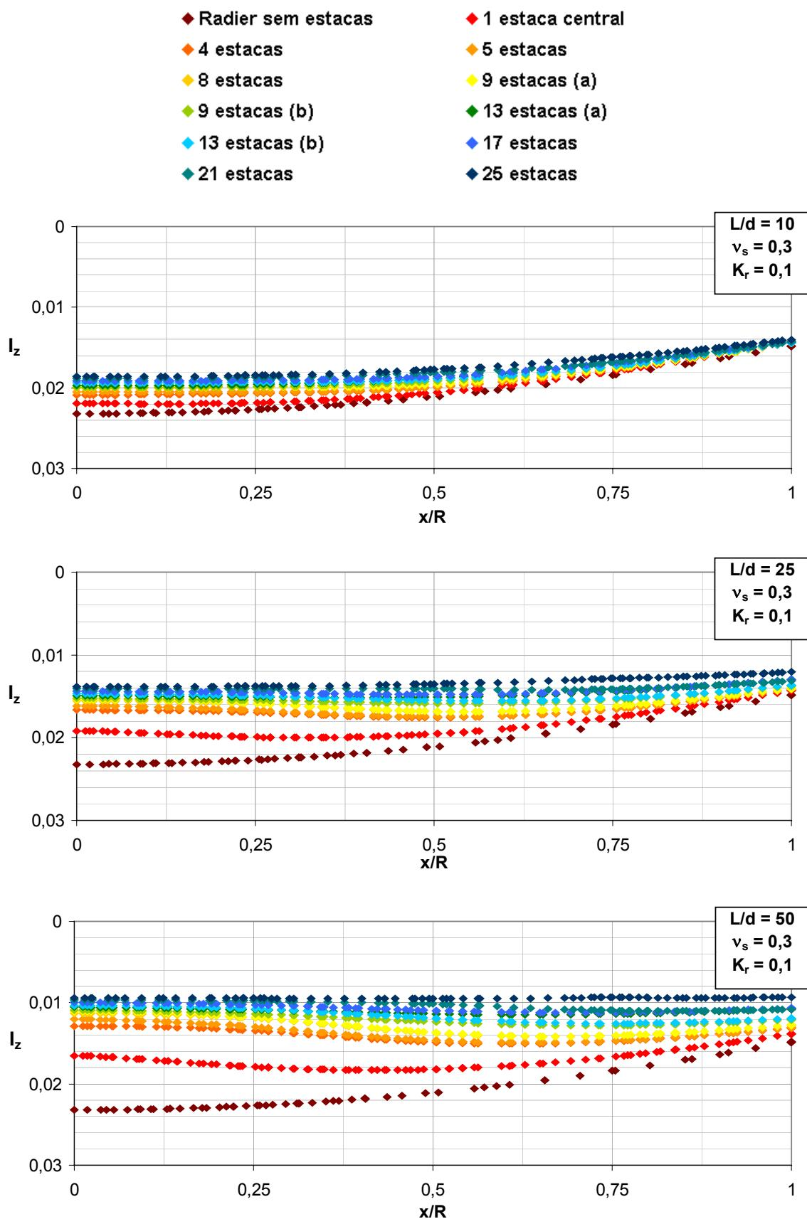
Figura A1. 14 – Efeito do arranjo das estacas e  $L/d$  na deflexão do radier ( $v_s = 0,3$ ,  $K_r = 0,1$ , seção B-B).
