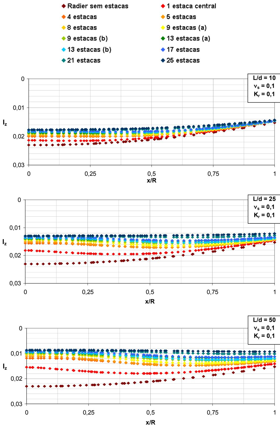
Figura A1. 6 – Efeito do arranjo das estacas e  $L/d$  na deflexão do radier ( $v_s = 0,1$ ,  $K_r = 0,1$ , seção C-C).
