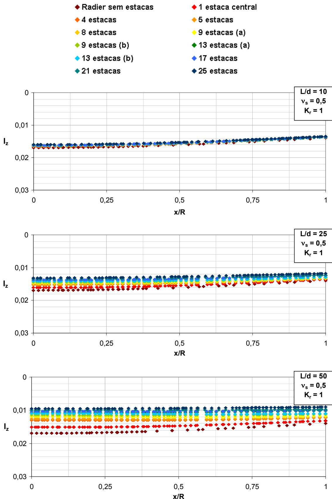
Figura A1. 26 – Efeito do arranjo das estacas e  $L/d$  na deflexão do radier ( $v_s = 0,5$ ,  $K_r = 1$ , seção B-B).
