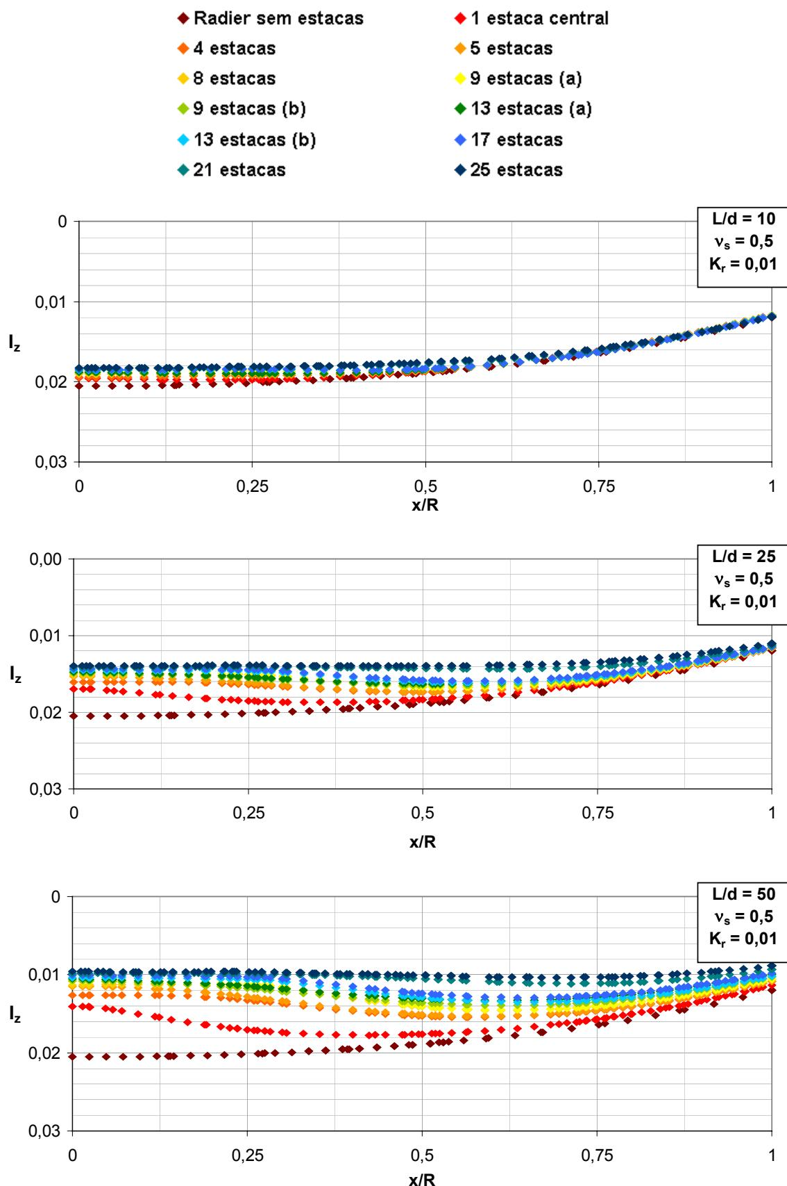
Figura A1. 21 – Efeito do arranjo das estacas e  $L/d$  na deflexão do radier ( $v_s = 0,5$ ,  $K_r = 0,01$ , seção C-C)
