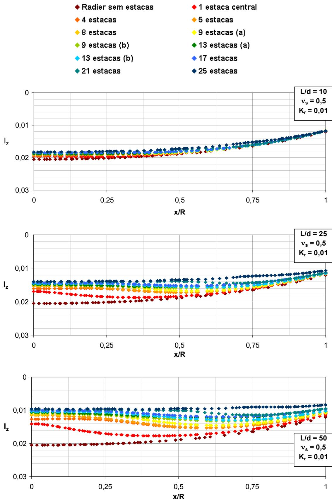
Figura A1. 20 – Efeito do arranjo das estacas e  $L/d$  na deflexão do radier ( $v_s = 0,5$ ,  $K_r = 0,01$ , seção B-B).
