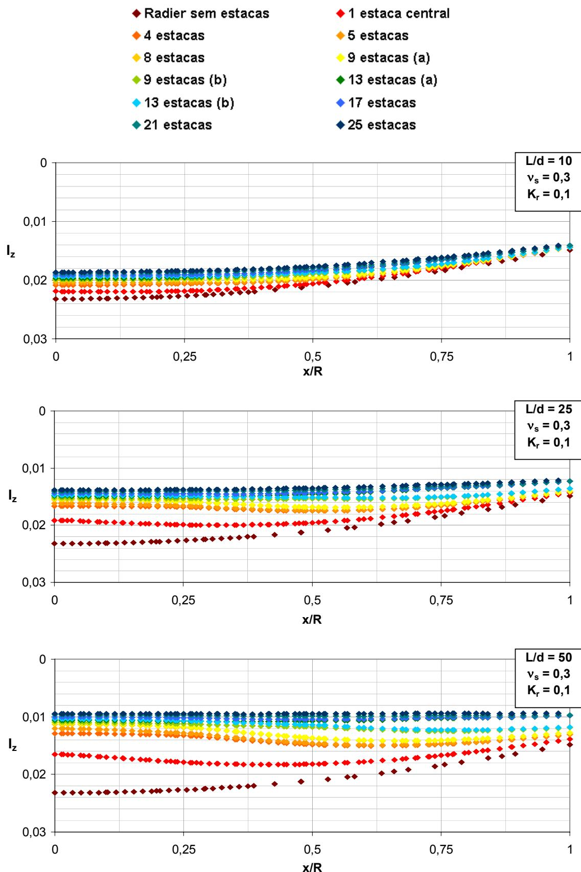
Figura A1. 13 – Efeito do arranjo das estacas e  $L/d$  na deflexão do radier ( $v_s = 0,3$ ,  $K_r = 0,1$ , seção A-A).
