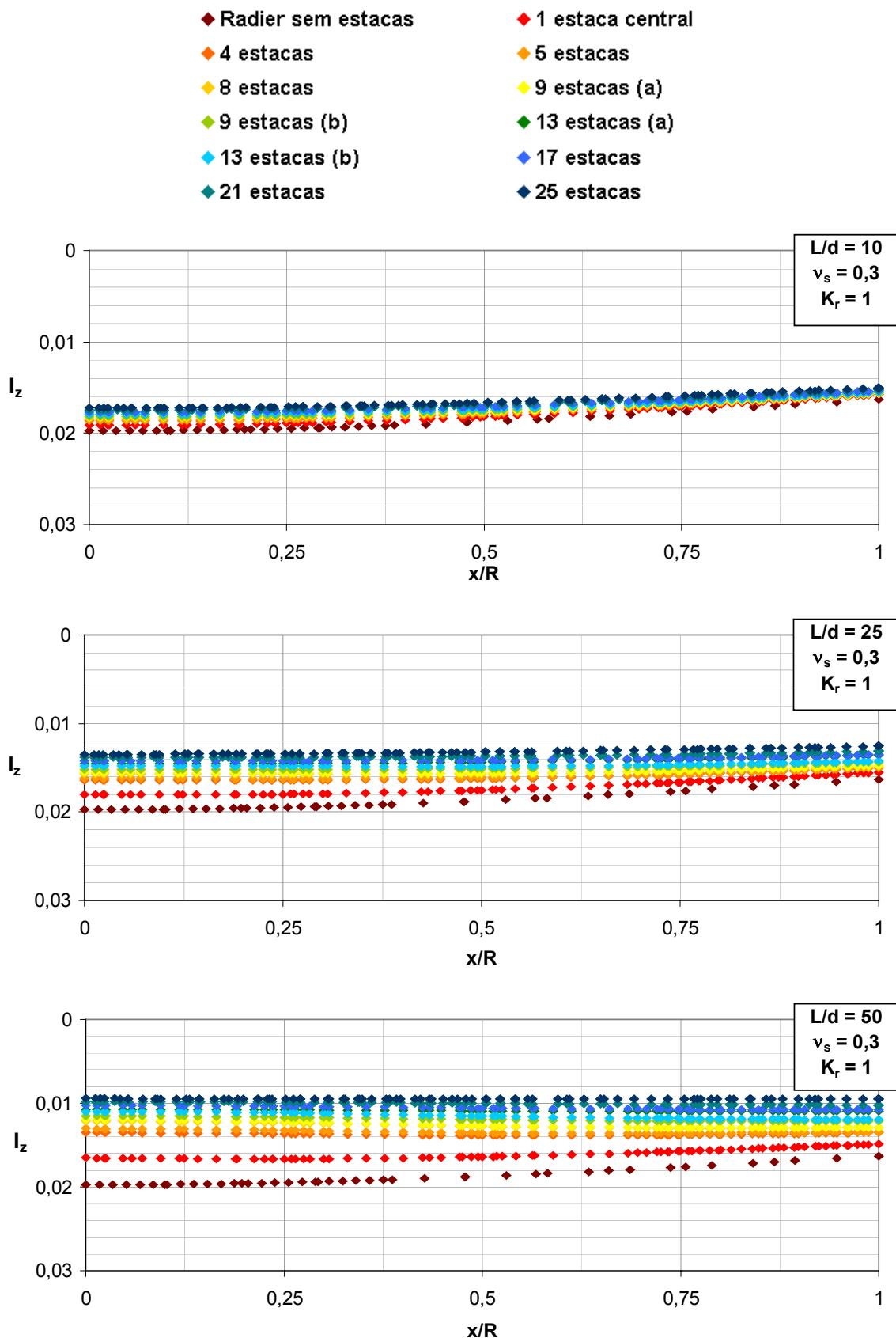
Figura A1. 18 – Efeito do arranjo das estacas e  $L/d$  na deflexão do radier ( $v_s = 0,3$ ,  $K_r = 1$ , seção C-C).
