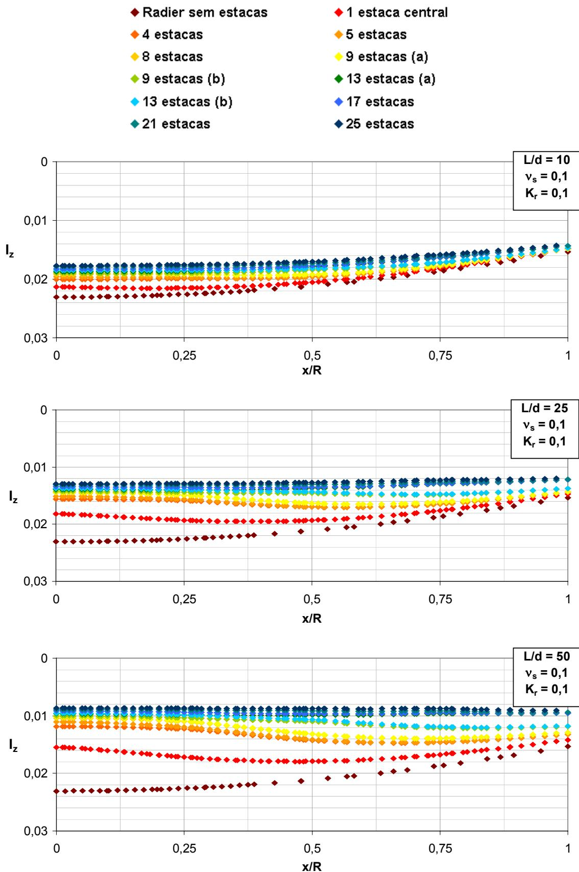
Figura A1. 4 – Efeito do arranjo das estacas e  $L/d$  na deflexão do radier ( $v_s = 0,1$ ,  $K_r = 0,1$ , seção A-A).
