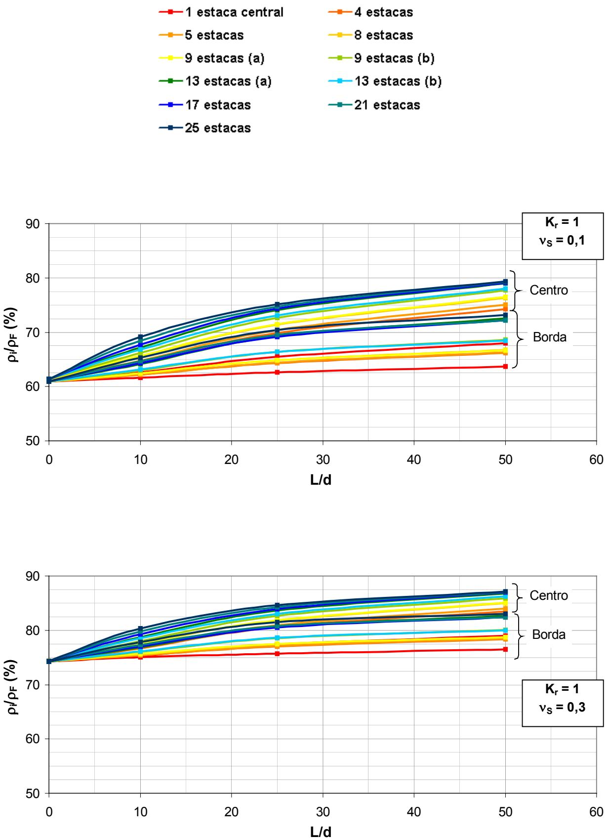
Figura A2. 3 – Recalque imediato  $\rho_i$  vs. recalque final  $\rho_F$  para  $K_r = 1$ .
