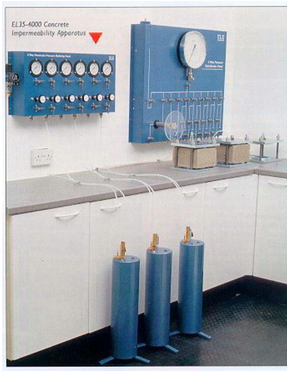
Figura 3.5 – Fotografia de tipo de permeâmetro com capacidade para testar 3 amostras simultaneamente.
