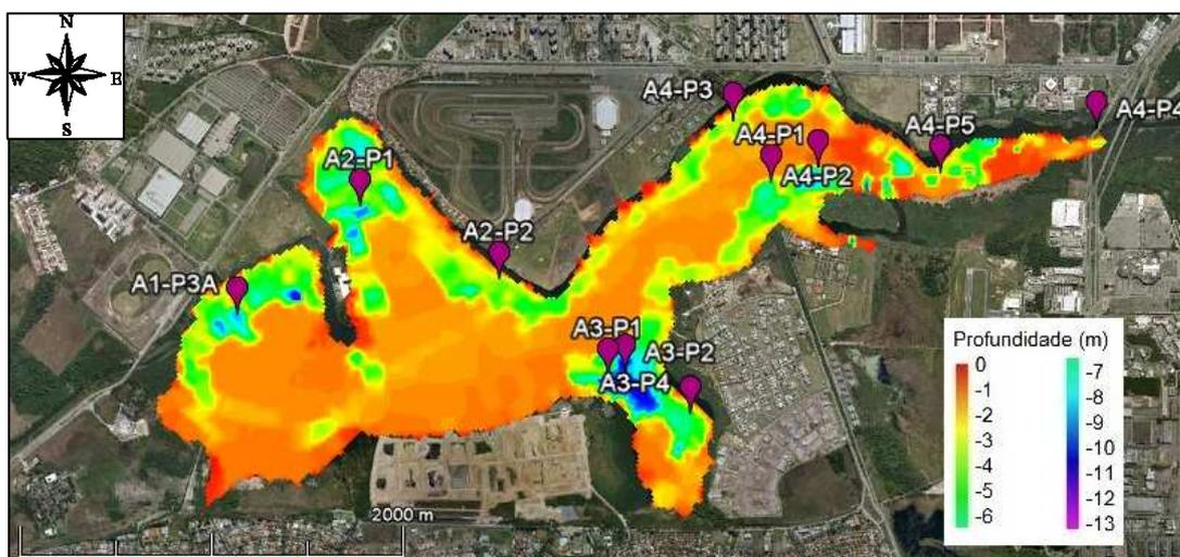
Figura 4.14 – Modelo batimétrico 2D com pontos de amostragem de matriz siltosa.
