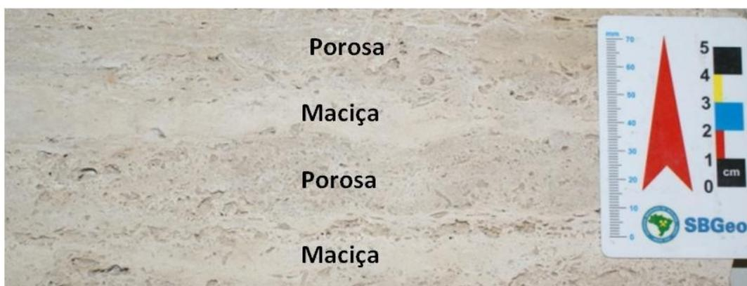
Figura 5.23 – Estrutura laminada com intercalações de bandas porosas e bandas maciças observada na amostra TRR-01 de travertino romano.
