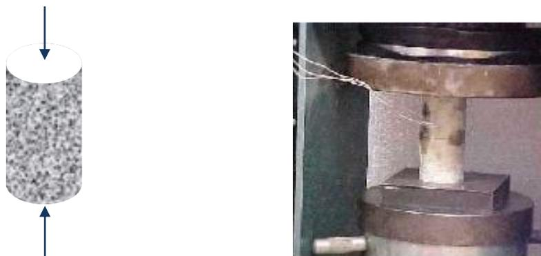
Figura 2.30 – Amostra no ensaio de compressão simples.
