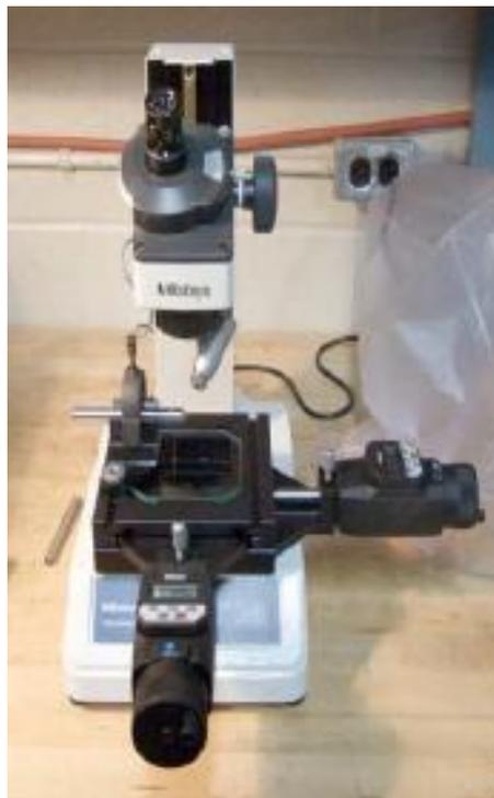
Figura 2.41 – Microscópio óptico utilizado na análise do desgaste da ponteira recomendada pela norma ASTM D7625-10 (Fonte: ASTM D7625-10).
