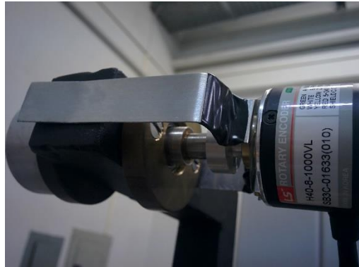
Figura 3.3 – Detalhe do encoder na estrutura
