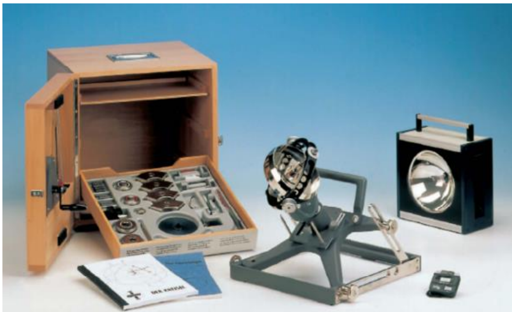
Figura 1.3 – Giroscópio de Magnus, da PHYWE
