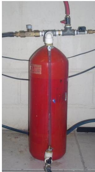
Figura 19. Tanque de Combustível Pressurizado.
