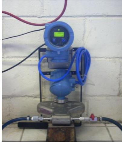
Figura 22. Medidor de Vazão de Combustível.
