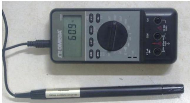
Figura 28. Medidor de Umidade Relativa.
