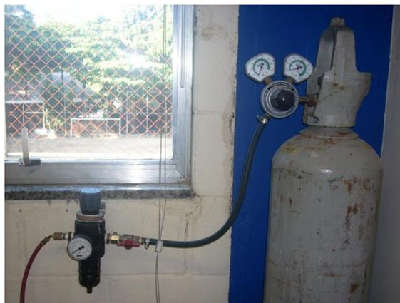
Figura 21. Regulador de Pressão e Tanque de Nitrogênio.
