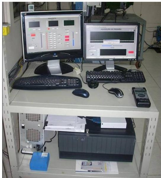
Figura 25. Visualização do Sistema de Aquisição e Processamentos de Dados.
