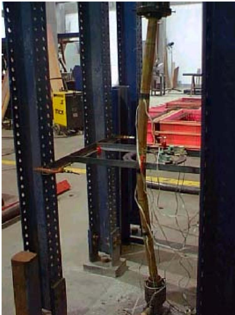
Figura 4.38. Ensaio de flambagem para corpo de prova de 1400 mm.
