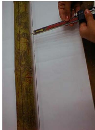
Figura 4.2. Leitura com paquímetro digital.
