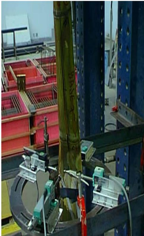
Figura 4.31. Esmagamento progressivo das fibras.
