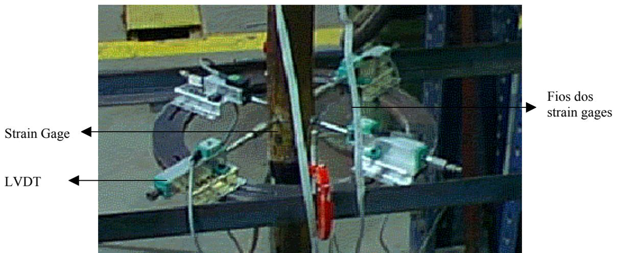
Figura 4.17. Posição dos strain gages no corpo de prova.
