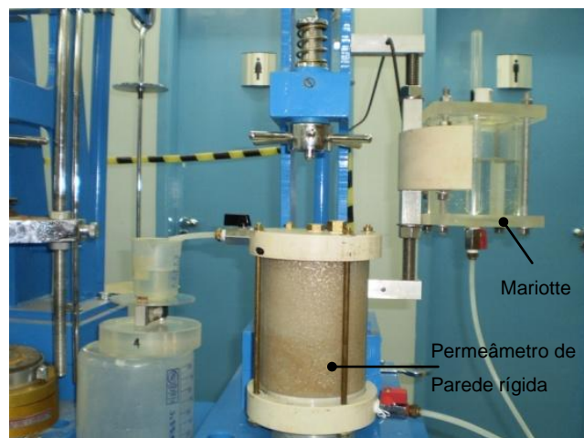
Figura 3.3. Aparato para a determinação da condutividade hidráulica saturada
