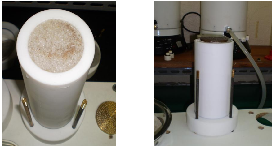
Figura 3.15. Vista superior e lateral da coluna após do processo de conformação da coluna de areia
