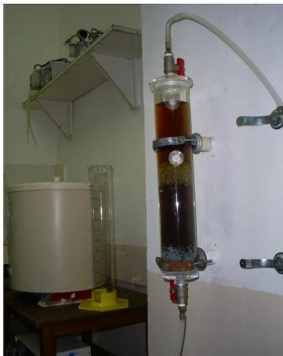
Figura 10- Coluna de biossorção contendo biomassa (*Cocos nucifera*)
