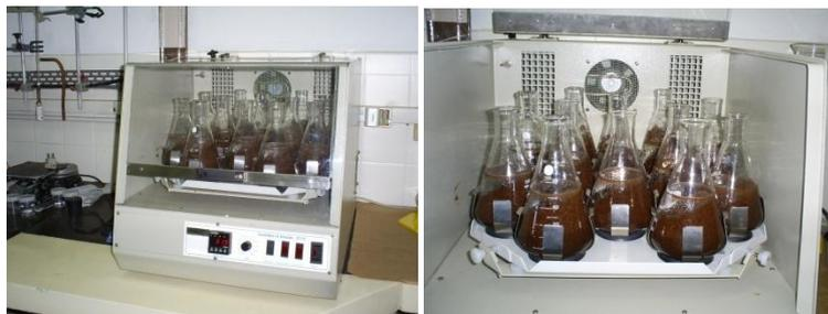
Figura 7- Equipamento utilizado para os testes de biosorção em processo de batelada.
