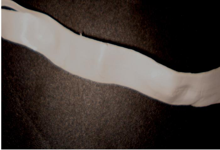
Figura 24 – Fita, após a extrusão, para ser utilizada para a confecção da membrana A.
