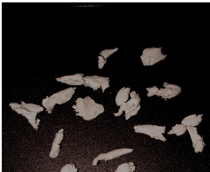
Figura 14 – Polímero 601A comercializado pela DuPont™ misturado ao óleo.
