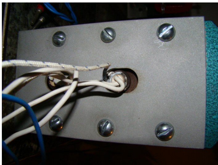
Figura 19a – Instalação das resistências dentro dos rolos do laminador.
