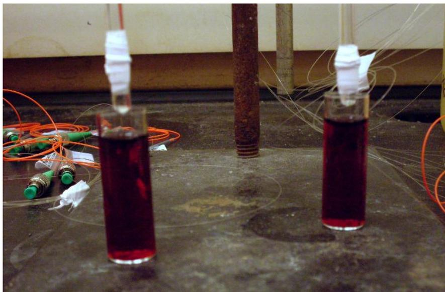
Figura 15: Fibras ópticas mergulhadas na solução de nanopartículas.
