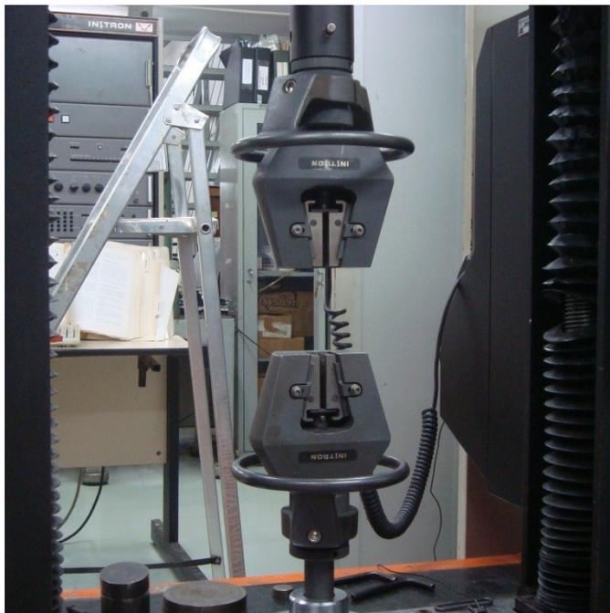
Figura 33: Máquina de ensaio de tração, Instron, modelo 5500R. ITUC, PUC-Rio
